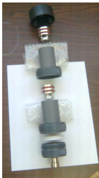
Figura 3.8.- Ensamblado del cabezal de PM 2.5 con protección para la lluvia
