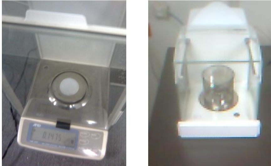
Figura 3.5.- Balanza Analítica y Micro balanza
