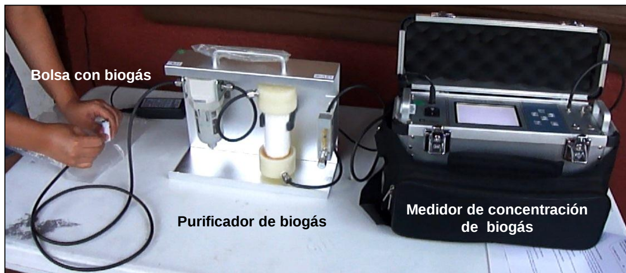
Figura 132. Calibración y medición del sistema de medición de concentración de biogás
