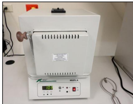
Figura 63. Secar cápsula de porcelana vacía en mufla
