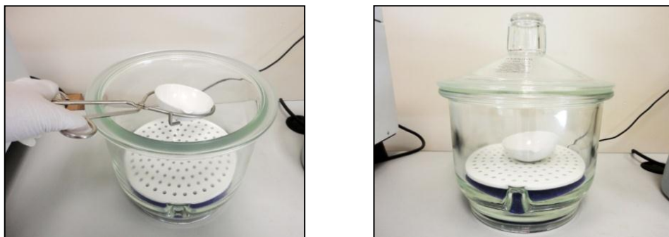
Figura 65. Enfriar cápsula de porcelana vacía en desecador
