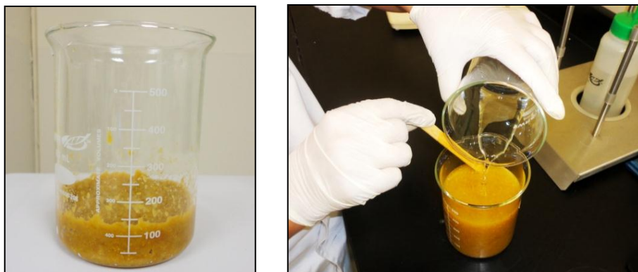
Figura 74. Toma y dilución de la muestra (residuo orgánico)
