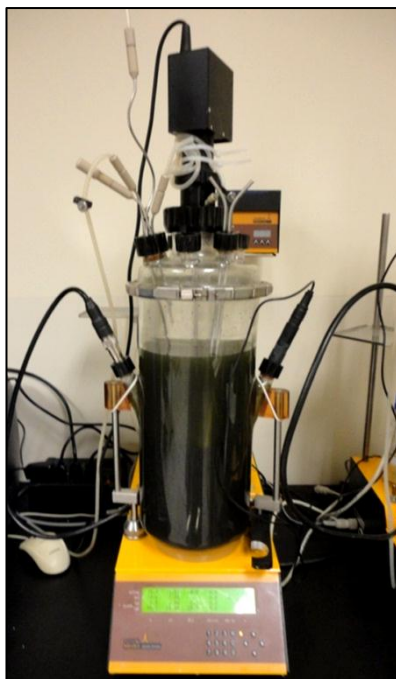
Figura 38. Digestor anaeróbico a escala laboratorio
