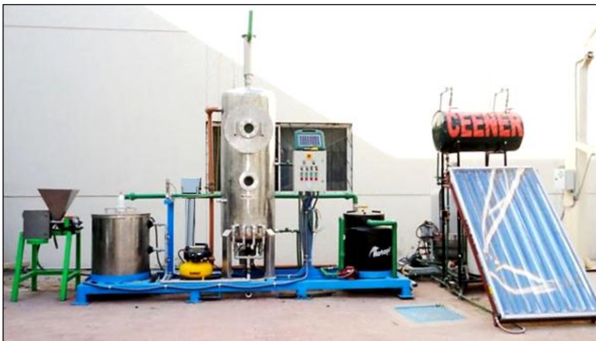
Figura 37. Digestor anaeróbico con flexibilidad para operar como CSTR o UASB acoplado a un subsistema de calentamiento solar y a una torre de enfriamiento.
