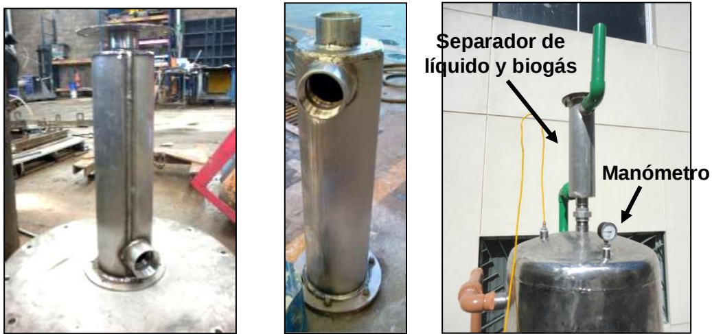
Figura 30. Separador de líquido-biogás y manómetro.
