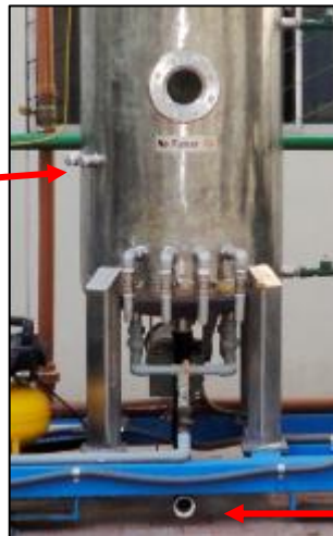
Figura 29. Purga de lodos anaeróbicos y entrada para sensores.
