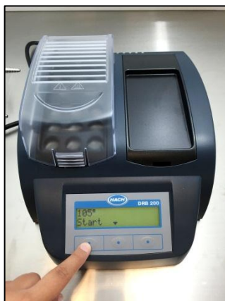
Figura 102. Precalentamiento del reactor DRB 200
