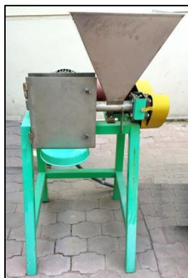
Figura 23. Molino triturador (pre-tratamiento mecánico).
