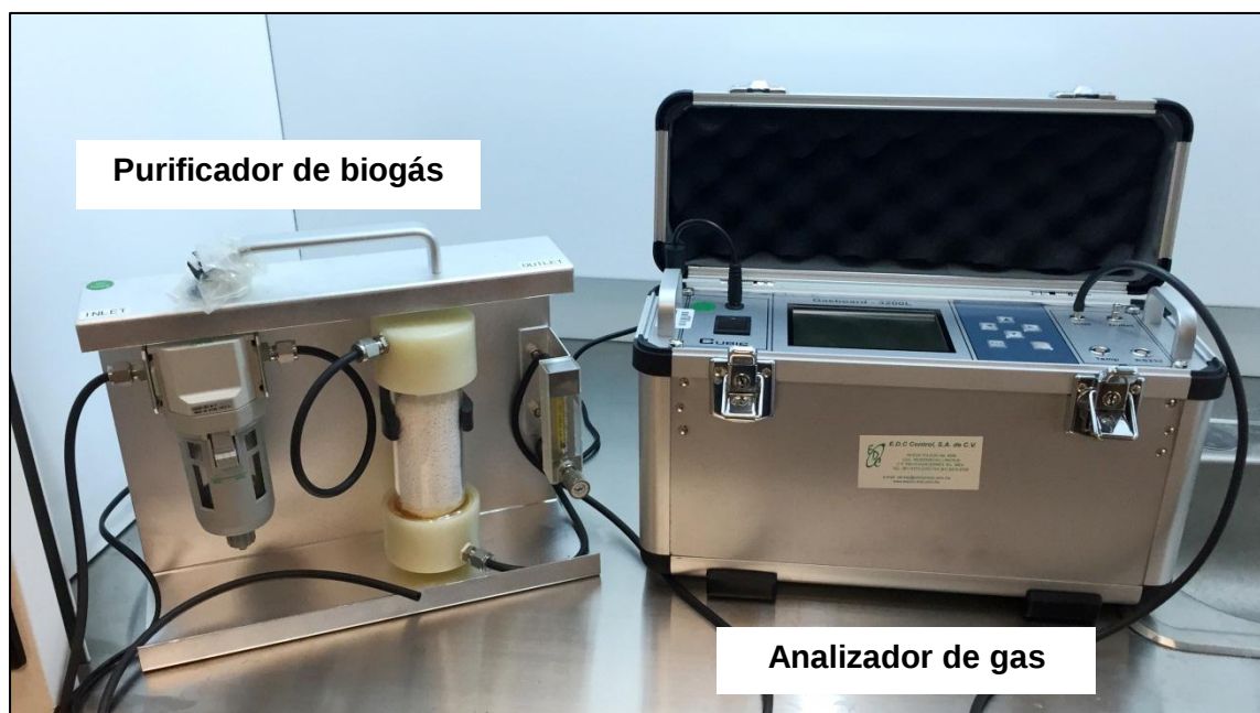
Figura 124. Equipo de medición de concentración de biogás
