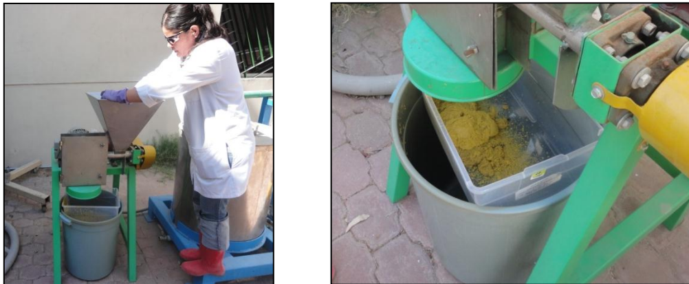
Figura 41. Pre-tratamiento mecánico al residuo sólido orgánico (trituration)
