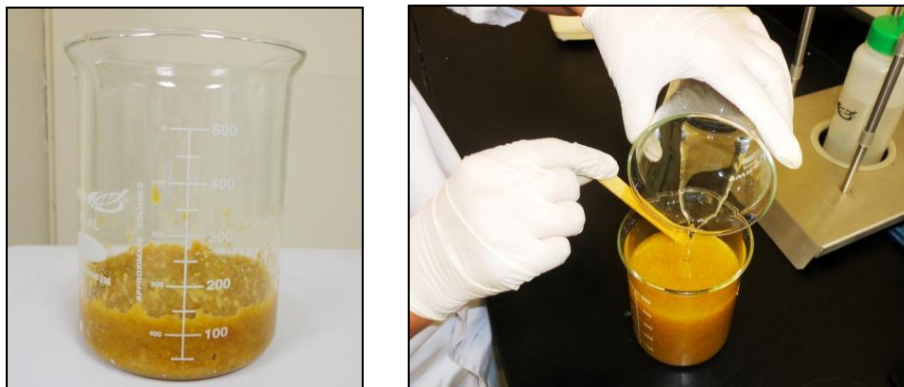
Figura 85. Toma y dilución de la muestra (residuo orgánico)
