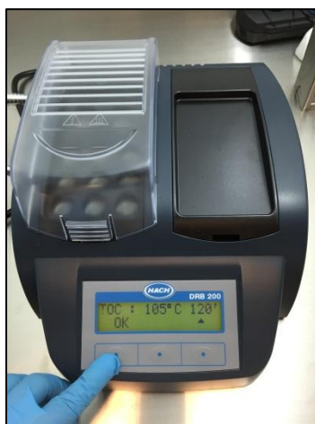
Figura 87. Precalentamiento del reactor DRB 200
