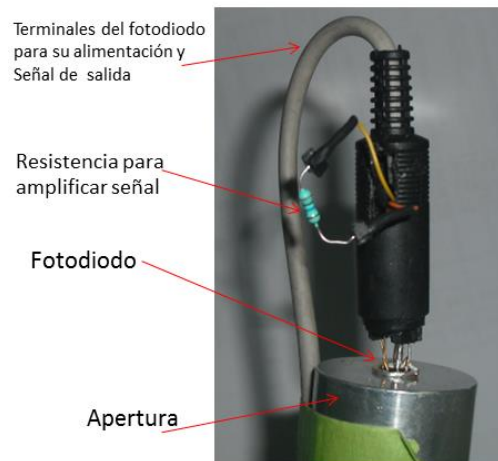
b) Imagen del fotodiodo montado en apertura de barrido
