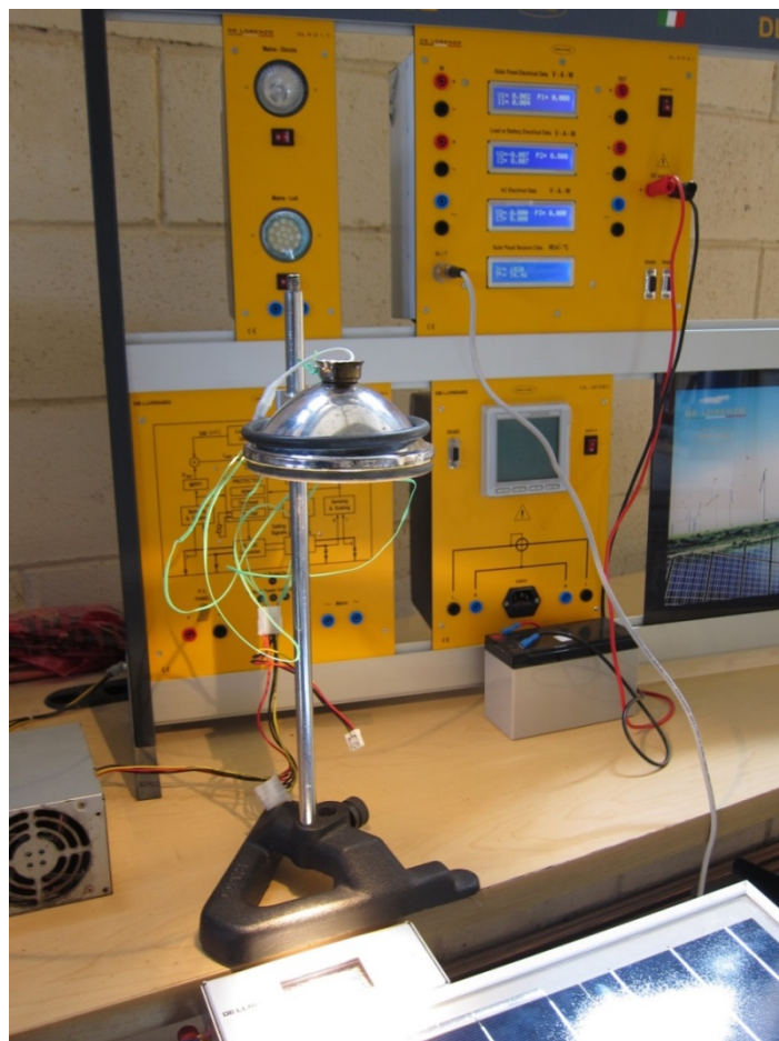
Imagen 17: Circuito elaborado en UABC-ECITEC para la estimación de la irradiancia solar emitida por la fuente con iluminación direccional de halógeno de cuarzo de 75 \text{ W} tipo H3, siendo de \approx 1000.2 \text{ W/m}^2 a una distancia de 32 \text{ cm} .
