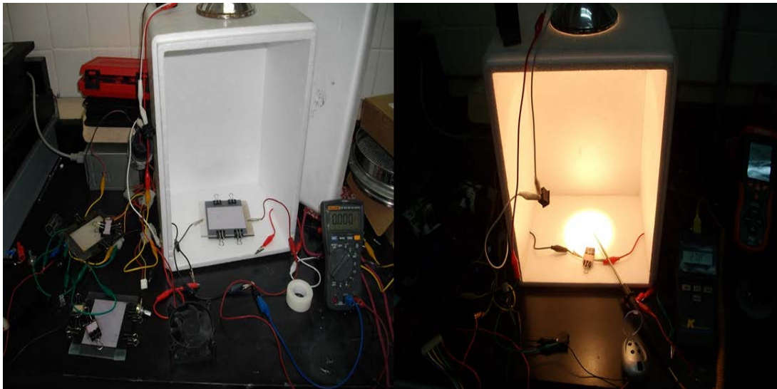
Gráfica 14: Prototipo elaborado para simular las condiciones de irradiación solar directa para la caracterización eléctrica de las celdas elaboradas y obtención de las curvas I-V, el cual cuenta con medición de temperatura (Termopar tipo K), intensidad luminosa (Luxómetro), control manual de temperatura mediante soplores tipo turbina, fuente regulada de 300 w, voltímetro y amperímetro.
