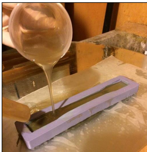
Figura 3.9: Resina Poliéster vertida en molde de silicón para probetas tipo I.
