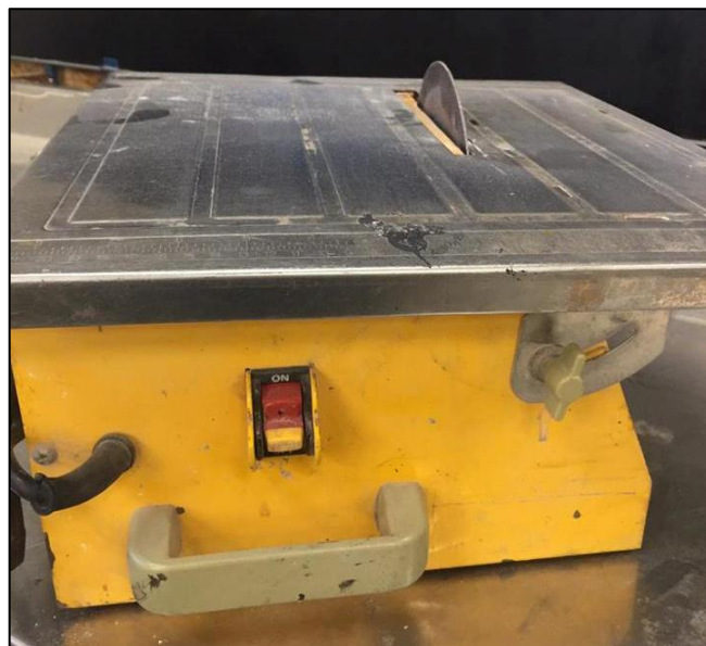
Figura 3.19: Sierra de corte utilizada para material compuesto
