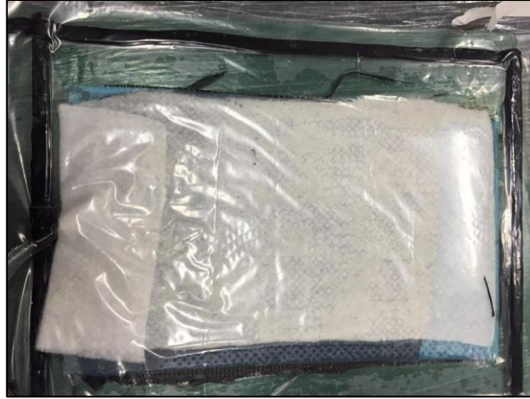
Figura 3.15: Manufactura al vacío de material compuesto de fibra de carbono y resina epóxica para pruebas de tensión.
