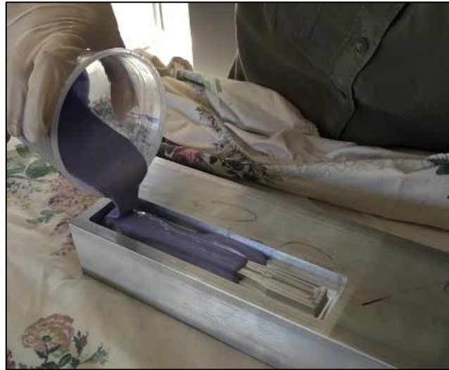
Figura 3.4: Vaciado de silicón en molde negativo de aluminio con geometría de probetas tipo 1 ASTM D638.
