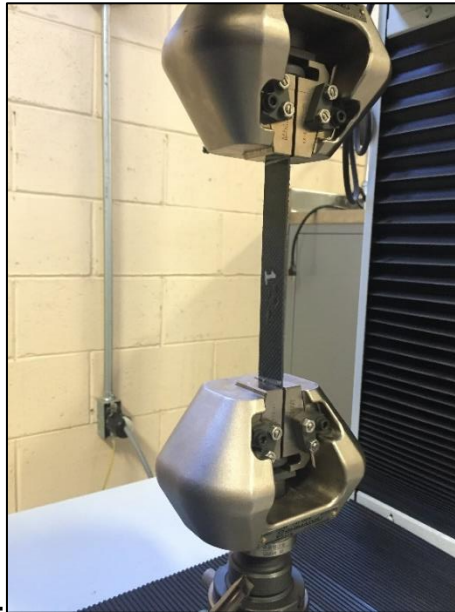
Figura 3.22: Probeta de material compuesto sometida a prueba de tensión.
