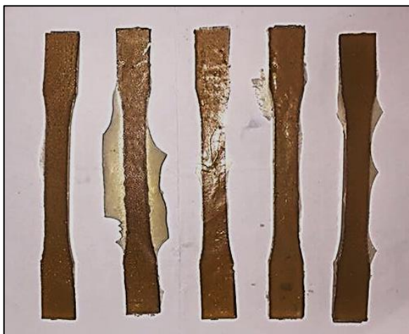
Figura 3.10: Especímenes de Resina Poliéster antes de Rectificado.
