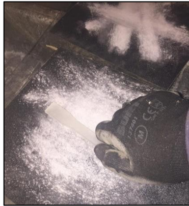
Figura 3.7: Rectificado de especímenes de resina epóxica con lijas a diferentes grados de orientación.
