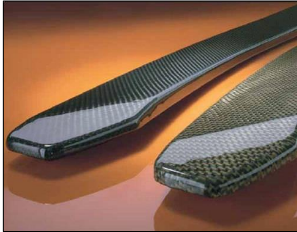
Figura 1.3: Fibra de carbono impregnada de resina epoxi. [14]
