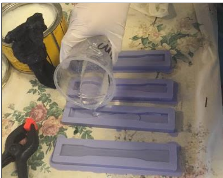
Figura 3.6: Mezcla vertida en moldes de silicón para probetas Tipo I.
