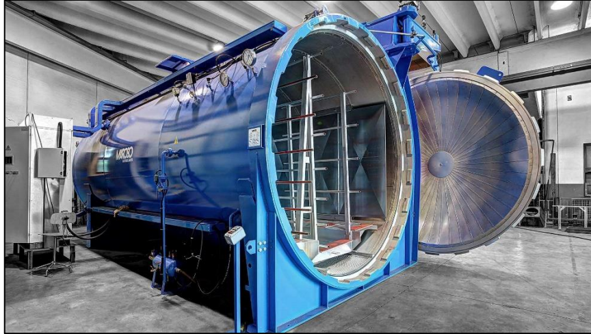
Figura 2.8: Autoclave para astilleros navales para materiales compuestos. [40]
