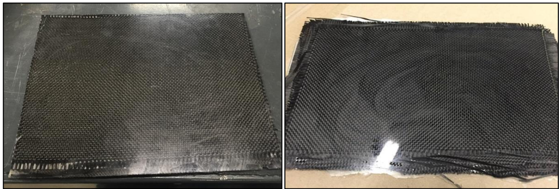
Figura 3.15: Manufactura al vacío de material compuesto de fibra de carbono y resina epóxica para pruebas de tensión.
