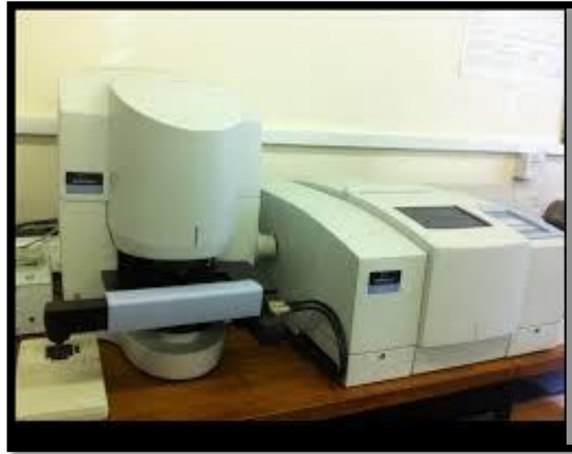
Figura. 4- 6: Equipo de espectroscopia infrarroja (FTIR) Perkin Elmer Spectrum One.
