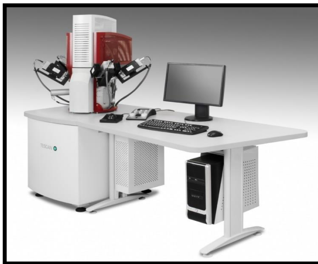
Figura. 4- 9: Microscopio electrónico de barrido Tescan Lyra 3.
