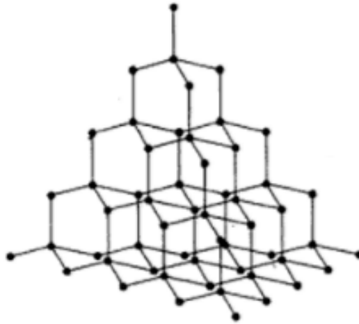
Figura 94. Representación de una estructura cristalina de diamante (Valenzuela Calahorro, 1995).
