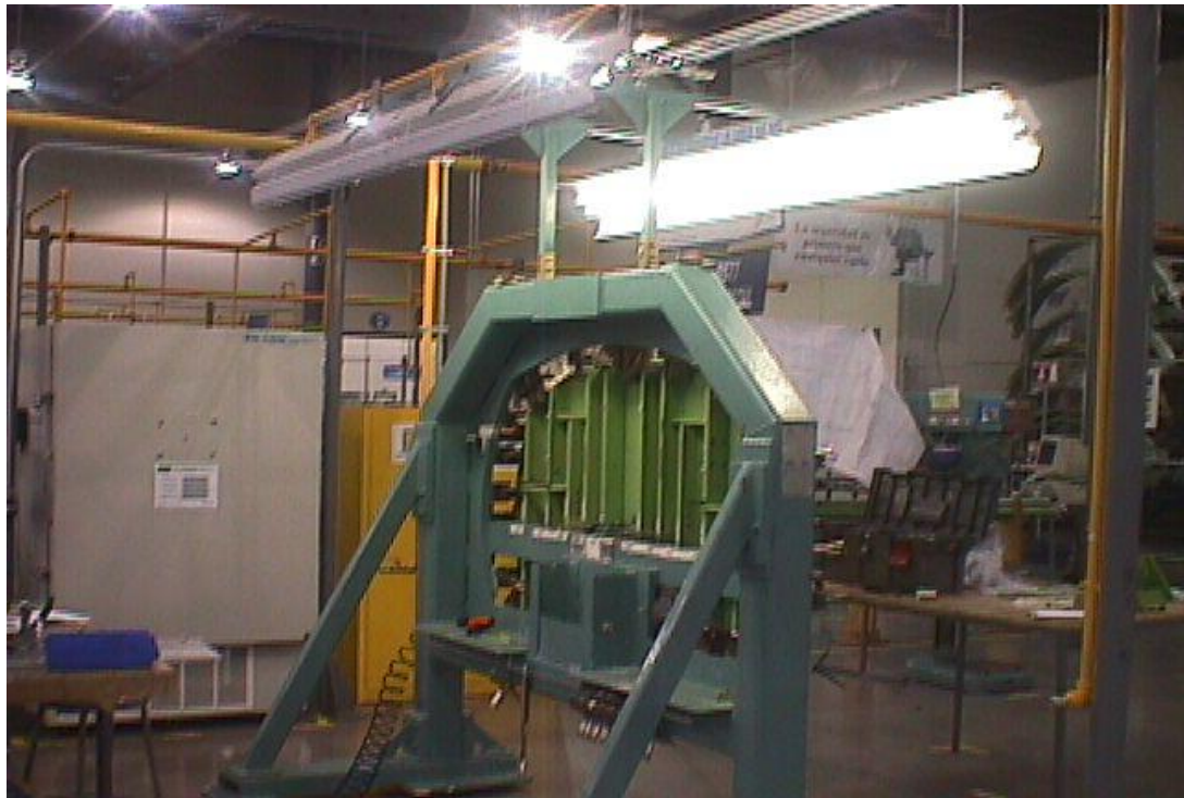
Figura 2.7 Plantilla del área de taladrado con luminarias.
