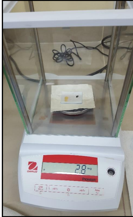
Figura 18. Pesado del cemento sellador AH Plus en una microbalanza de precisión.
