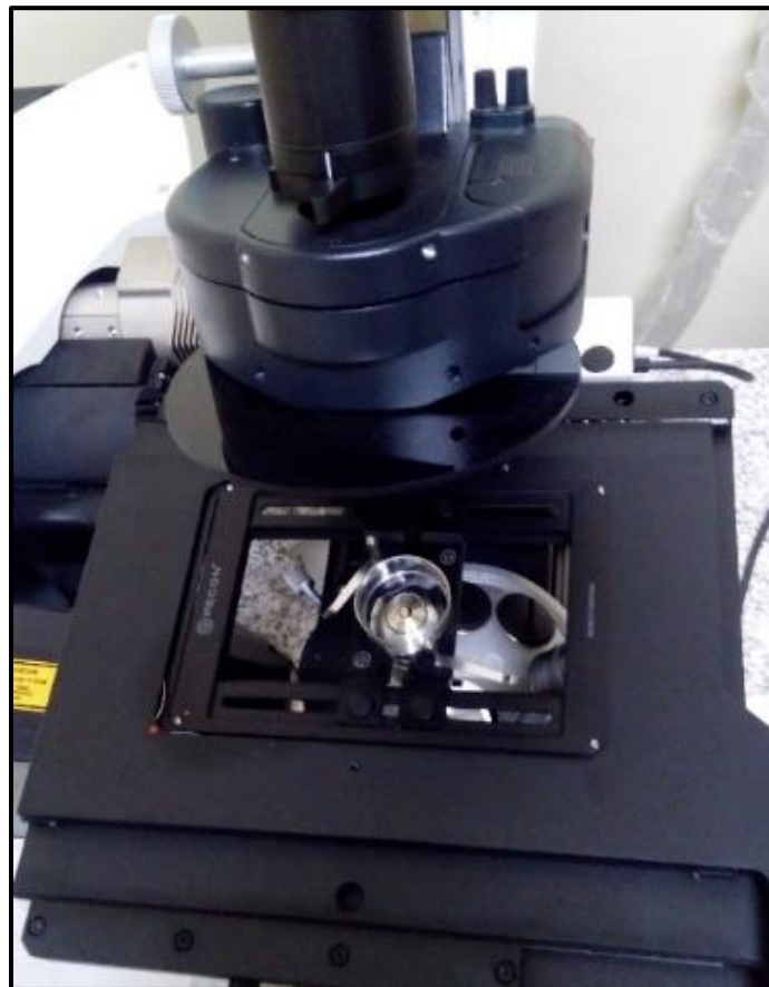
Figura 33. Fotografía de la muestra montada en la platina del el microscopio de fluorescencia confocal Leica SP8 TCS.
