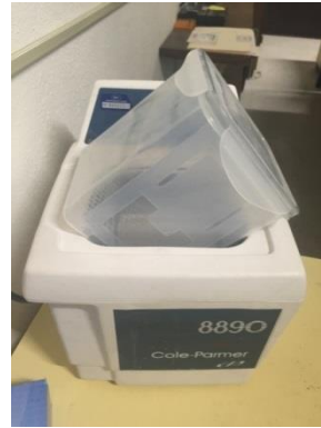
Figura (10). A) Agitación del molde en una cama de alcohol B) Baño de ultrasonido.
