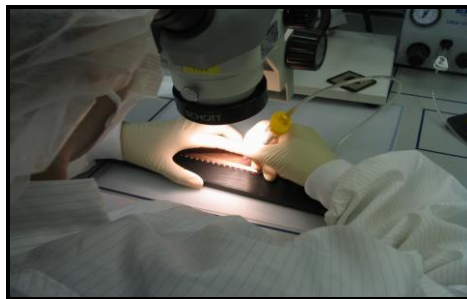
Figura 20.- Aplicación y verificación de epóxico
