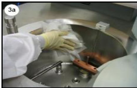
Figura 33.-Desinfección del interior de la cámara
