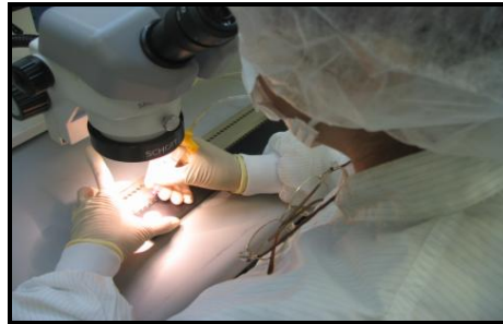
Figura 133.-Aplicación de epóxico
