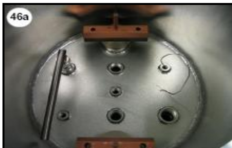
Figura 67.-Interior de la cámara de sellado
