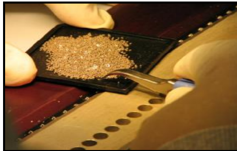
Figura 134.-Colocación del capacitor
