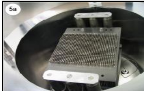
Figura 34.-Colocación de feedthru en la cámara
