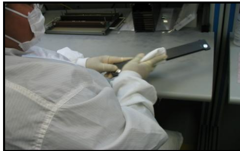
Figura 130.-Limpieza de la cubierta del riel con alcohol y toalla
