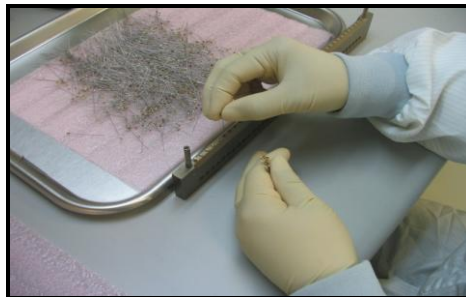
Figura 25.-Colocación de feedthru en plantilla
