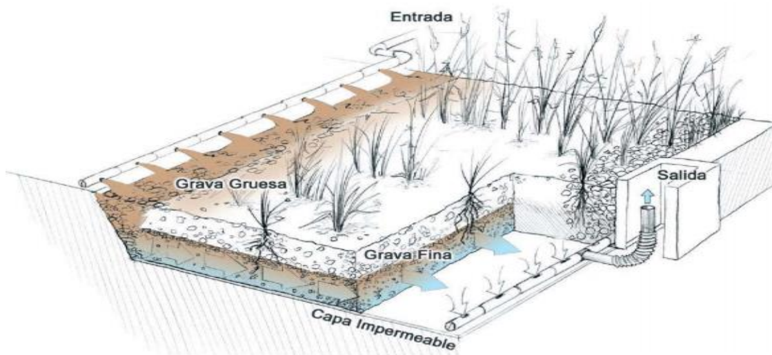
Figura 6. Esquema HFSS-H Fuente: http://depuranatura.blogspot.com.es
