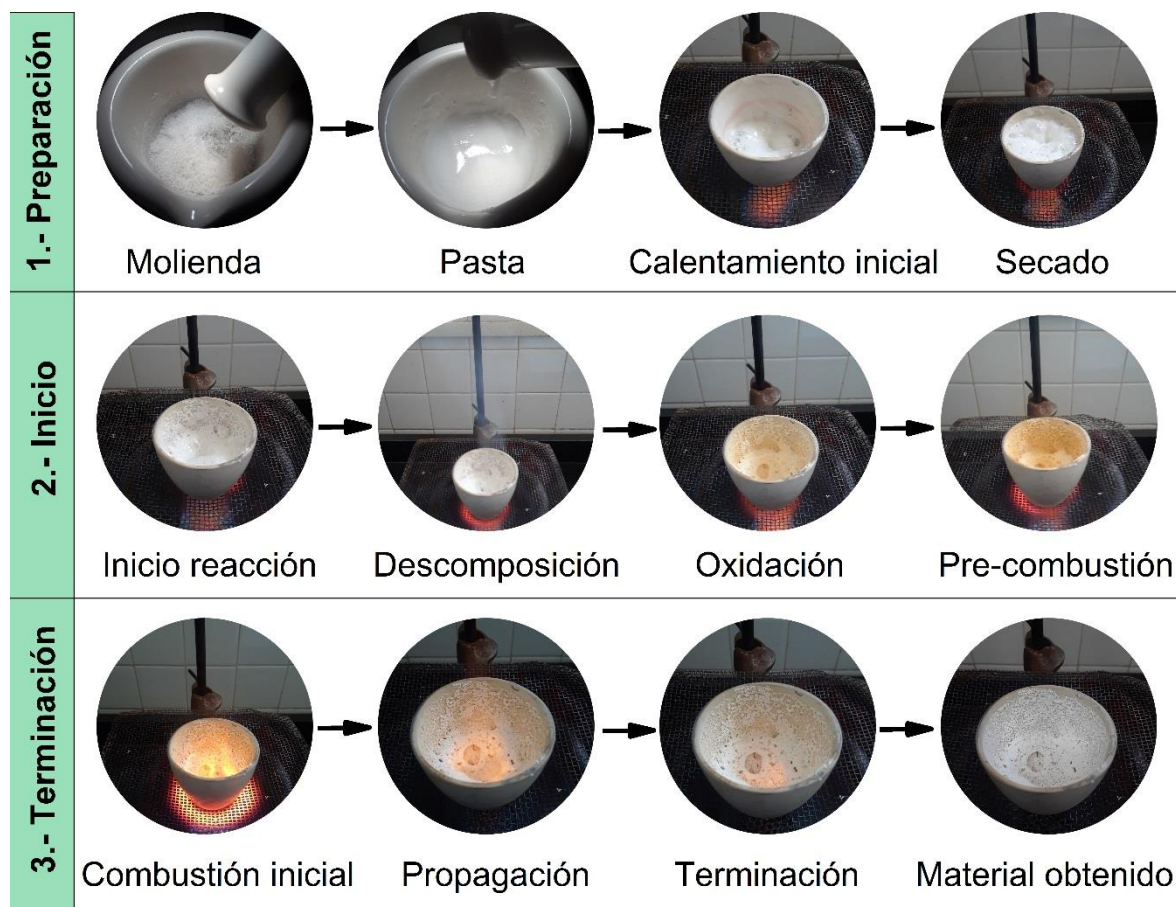
Figura 10. Proceso experimental de síntesis por combustión para HAP.
