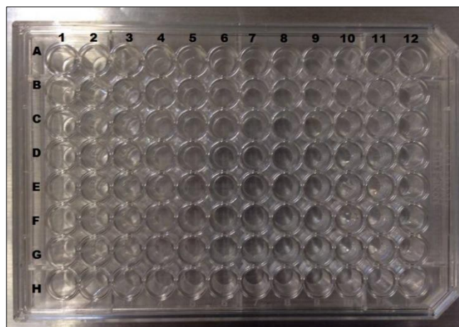
Figura 2.6 Disposición de pozos en una microplaca.
