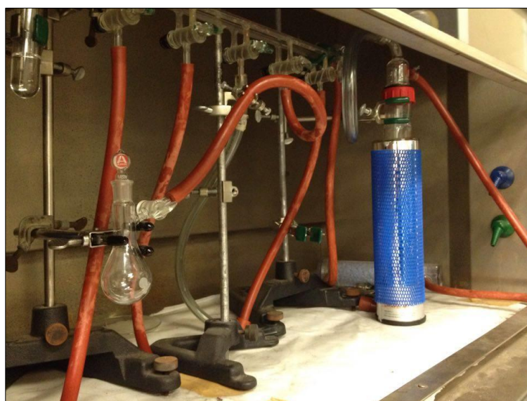
Figura 2.2 Equipo de secado al vacío para muestras sensibles al agua.
