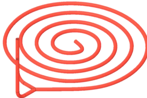
Figura 29 Vista isométrica de espiral para separar microfluidos
