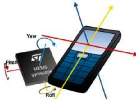
Figura 2 Dispositivo MEMS en equipo móvil para definir orientación y la aceleración. Actualmente todos los dispositivos móviles utilizan un giroscopio de este tipo.
