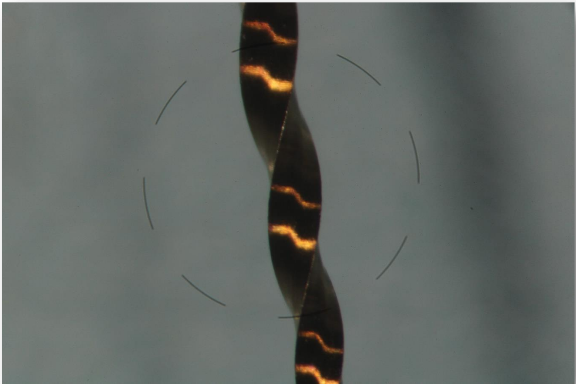
Figura 6 se observa un instrumento (Hyflex) con microscopio óptico con un objetivo de 40x
