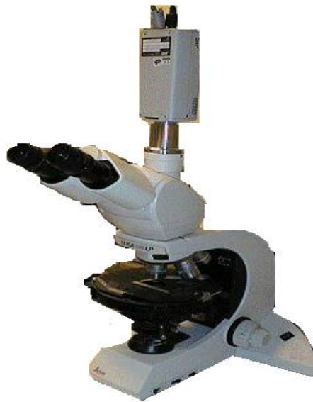
Figura 2.7. Microscopio óptico con cámara CCD .
