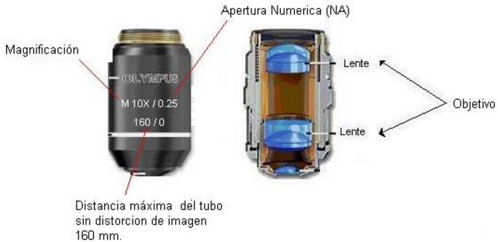
Figura 2.3 . Estructura del lente objetivo.
