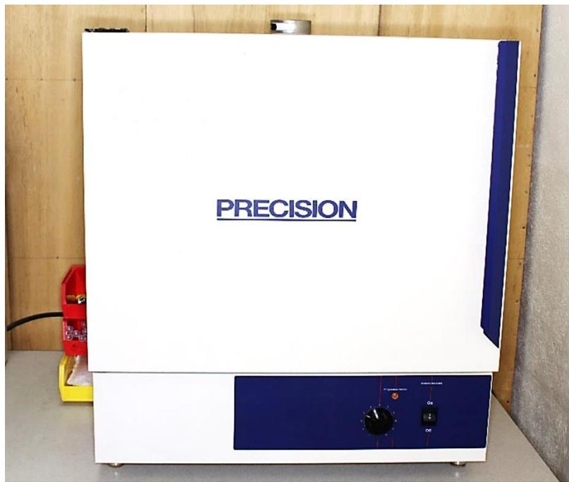
**Figura 9. Incubadora GCA/Precision.** Se almacenaron los especímenes a 37° C.
