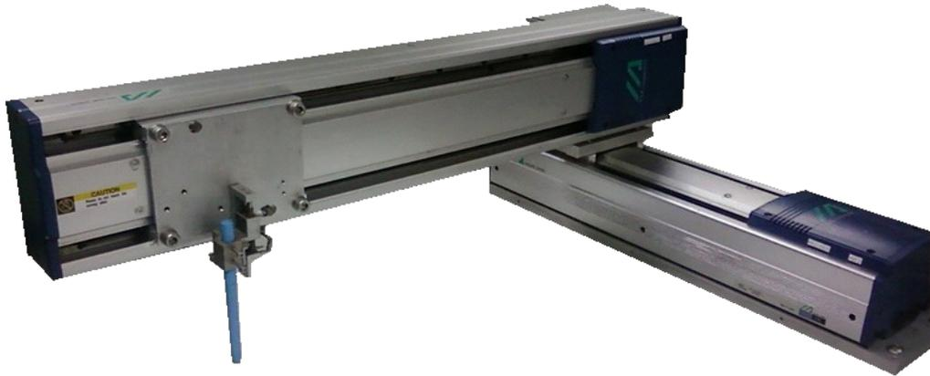
Figura 4.6. Sistema bidireccional de dos ejes.
