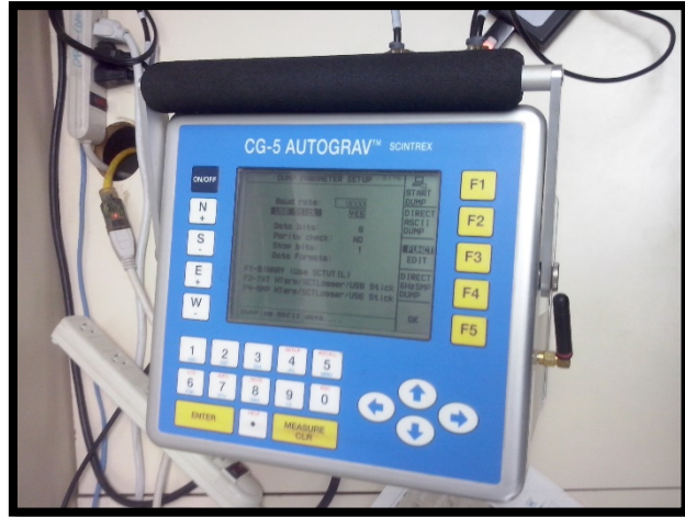
Figura 3-5. Observación en modo cíclico para la corrección de marea instrumental de gravímetros CG-3 y CG-5.
