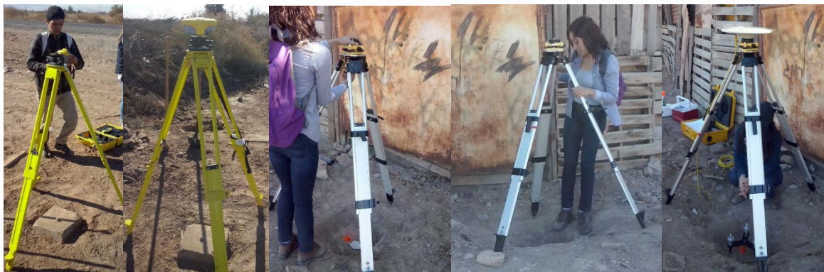
Figura 3-9. Colocación de tripié, base de nivel, centrado sobre banco geodésico e instalación de antena del sistema GPS.
