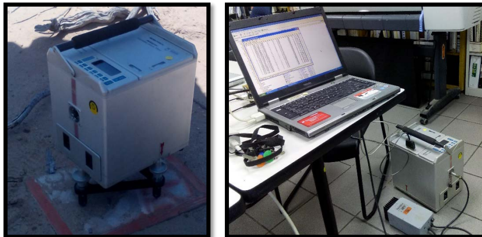
Figura 3-7. Gravímetro relativo CG-3 de Scintrex . Izquierda toma de datos en banco P2A8 de la RGFI sobre dispositivo de nivelación y derecha muestra la descarga de datos.
