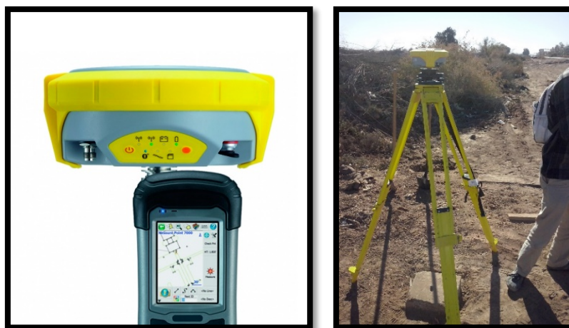
Figura 3-12. Derecha equipo GPS Geomax Zenith25 (Geomax, 2017), (izquierda) posicionamiento en banco de la RGFI (P3A5).
