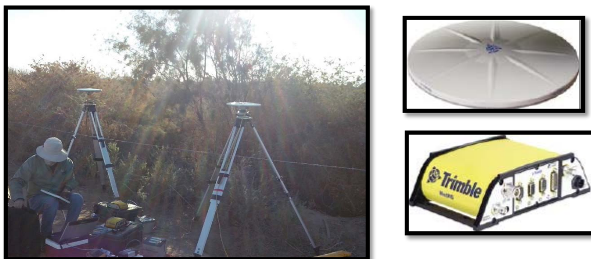
Figura 3-10. Sistema de medición GPS Trimble NetRS (Derecha inferior) y antena Zephyr Geodetic (Derecha superior). Izquierda configuración e instalación en campo.
