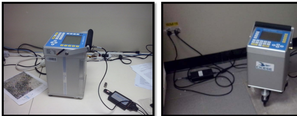
Figura 3-8. Gravímetro relativo CG-5 de Scintrex . Izquierda descarga de datos en memoria externa vía cable serial RBS ( Scintrex , 2009); derecha gravímetro conectado a fuente de alimentación externa sobre dispositivo de nivelación.
