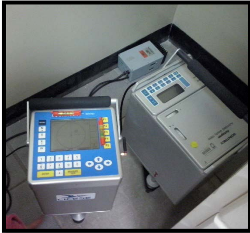
Figura 3-5. Observación en modo cíclico para la corrección de marea instrumental de gravímetros CG-3 y CG-5.
