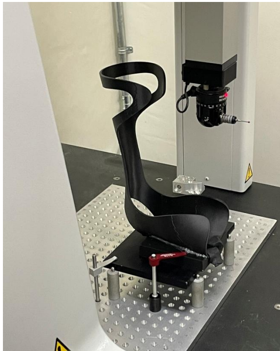
Figura 44: Cambio de configuración de herramienta de 0 grados a 90 grados.
