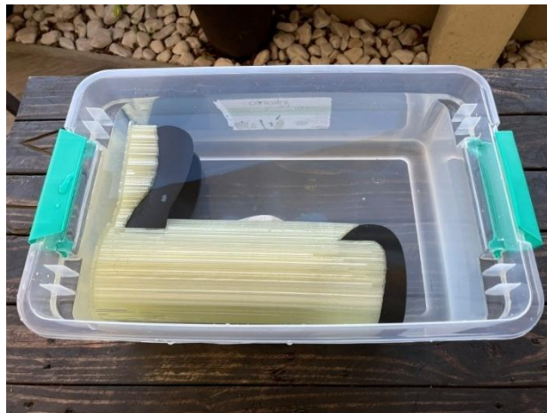
Figura 35: Remoción en agua de soportes PVA.
