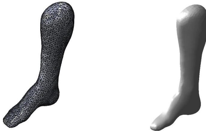
Figura 20: Generación de cuerpo solido de un mallado.
