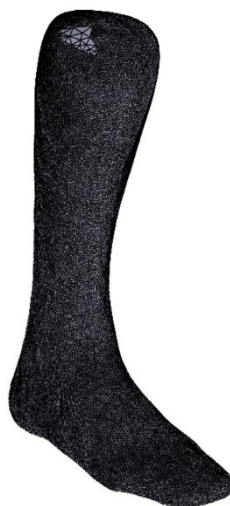
Figura 19: Malla resultante de los datos geométricos del pie-tobillo.
