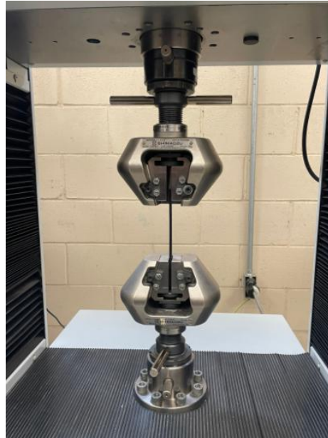
Figura 14: Máquina de tensión realizando el trabajo de tracción en probeta.
