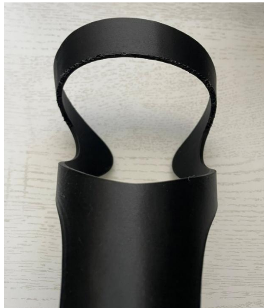
Figura 30: Impresión de primer modelo de impresión con material de soporte PETG-CF caída trasera de soporte.
