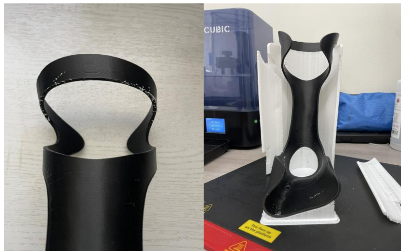
Figura 33: Impresión del modelo de impresión con material de soporte PLA.
