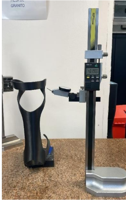
Figura 38: Alineación de ortesis con molde.
