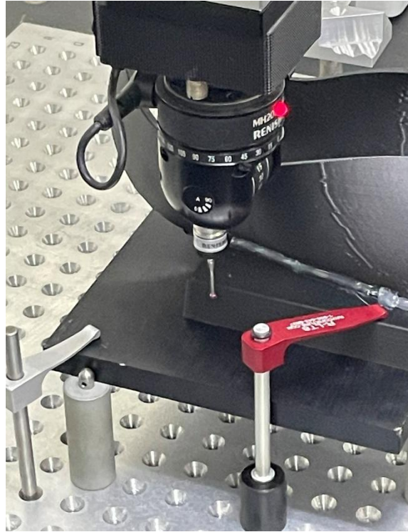
Figura 43: Palpado a los planos laterales para su configuración.
