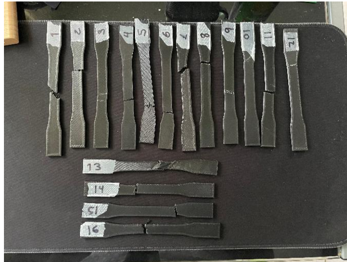
Figura 15: Probetas con ruptura
