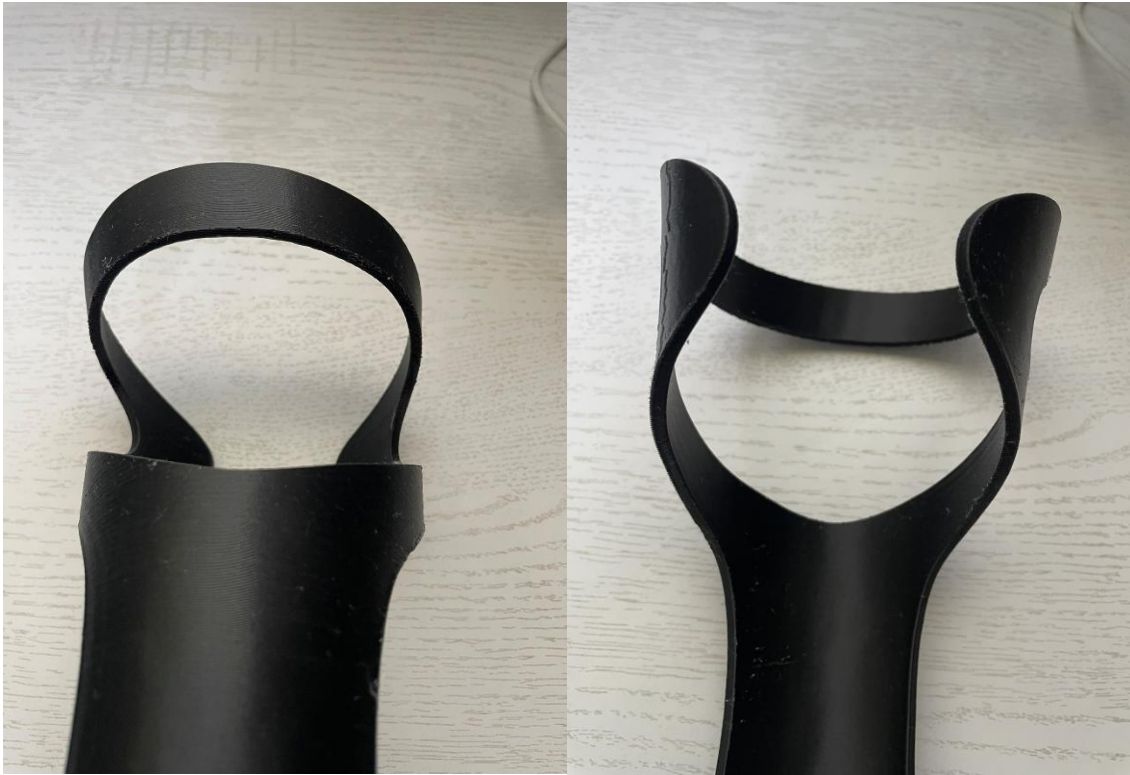
Figura 36: Impresión del modelo de impresión con material de soporte PVA, caída trasera de soporte.
