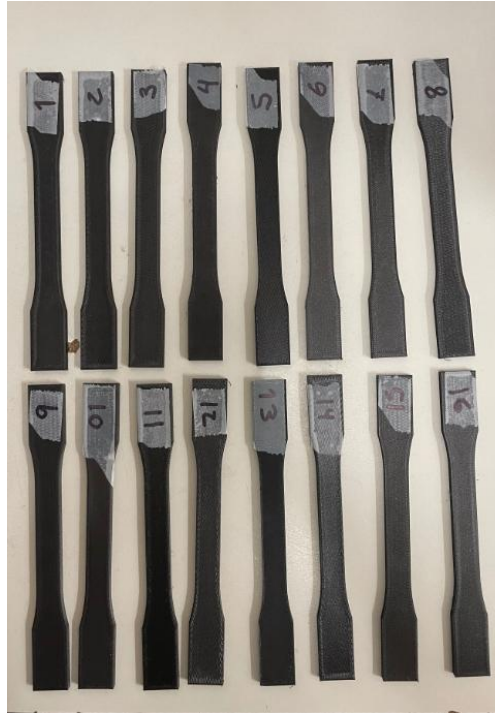
Figura 13: Modelos de la ASTM D638 impresos en FFF con PETG-CF según el DOE de la matriz ortogonal L 16
