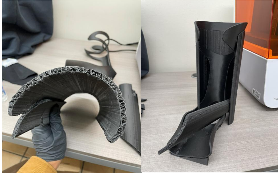
Figura 31: Impresión de primer modelo de impresión con material de soporte PETG-CF removiendo soportes.
