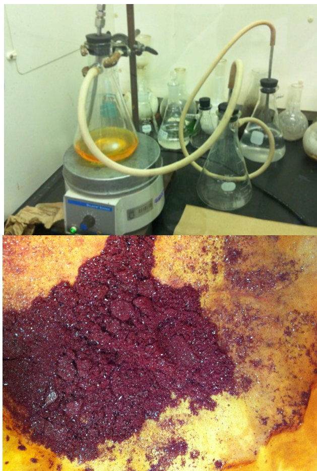
Figura 8. Preparación del TTMA: a) aparato para sulfidar la solución alcalina de heptamolibdato de amonio, b) detalle del tiomolibdato de amonio.
