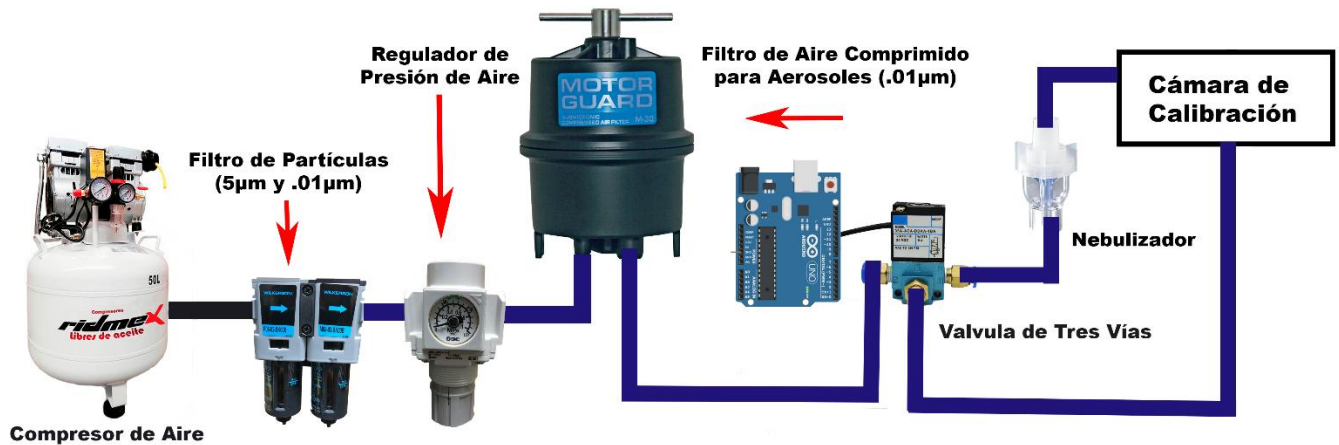
Figura 15. Diagrama del generador de partículas monodispersas.
