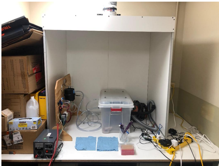
Figura 26. Prototipo de cámara de calibración dentro de la campana de extracción.
