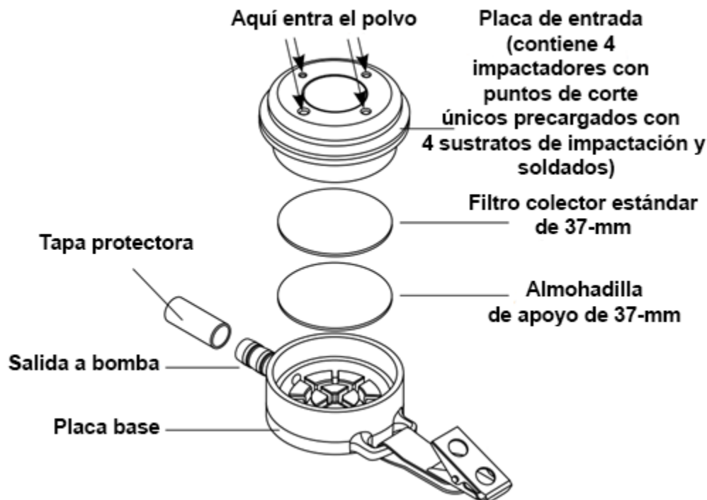
Figura 6. Estructura del impactador. (Fuente: Airmet)
