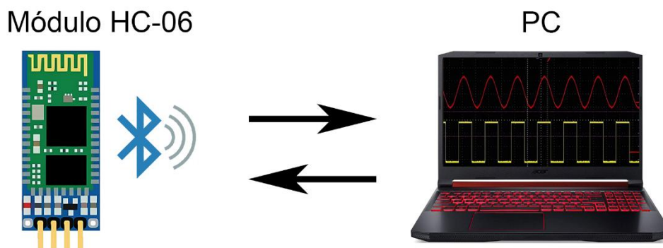
Figura 14. Diagrama de comunicación entre el módulo HC-06 y un ordenador (PC).
