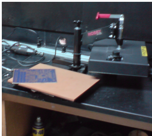
(a) Proceso de planchado de la hoja de transferencia en la lámina de cobre.
