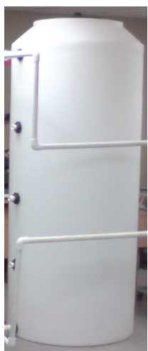
(a) Tanque sin aislamiento.
