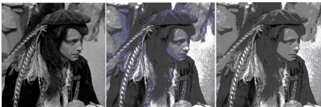
Figura 2.12: Imagen de entrada (izquierda), Segmentación por Otsu (centro), método QPSO (derecha) [6]
