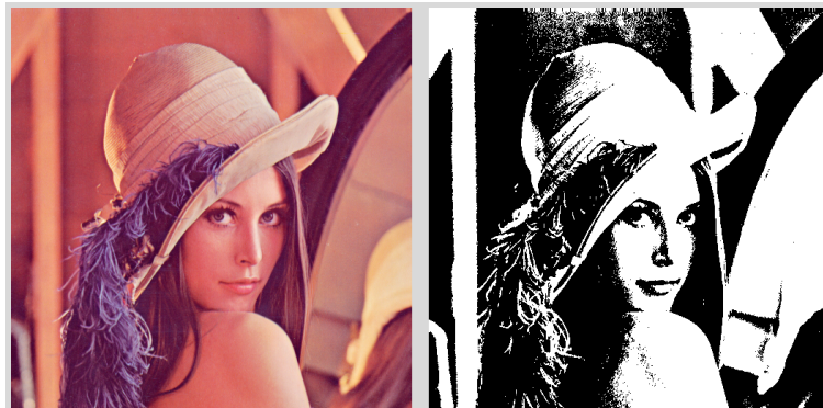
Figura 2.4: Ejemplo umbral adecuado implementado, T = 120
