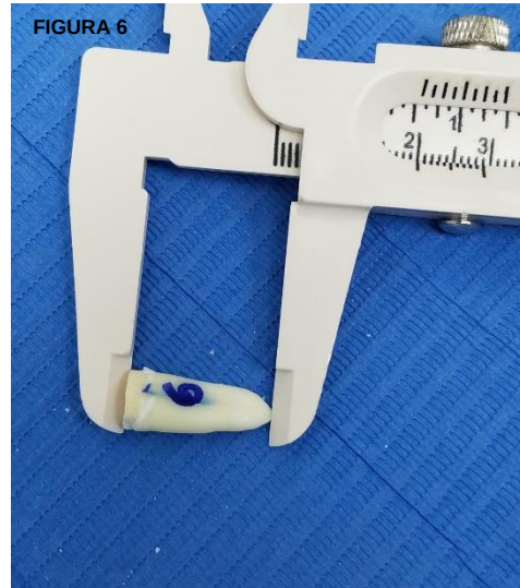
Figuras 5 y 6. Muestra corte de corona con baja velocidad y disco de diamante hasta estandarizar a 20 mm.
