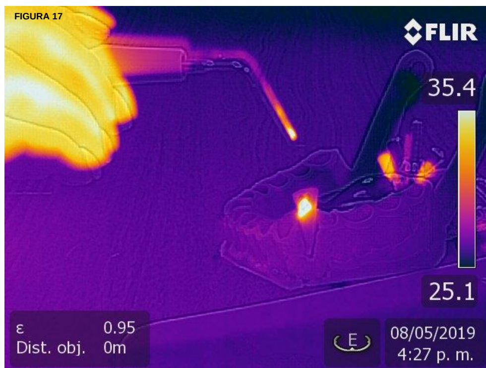
Figura 17. Muestra imagen termográfica donde se realiza protocolo 10 s sin enfriamiento.
