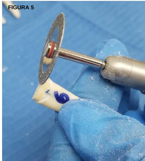
Figuras 5 y 6. Muestra corte de corona con baja velocidad y disco de diamante hasta estandarizar a 20 mm.
