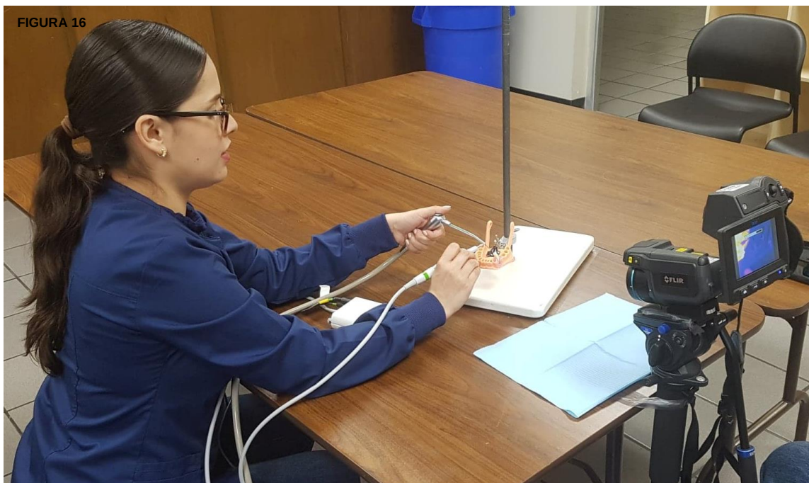
Figura 16. Muestra campo de trabajo para mediciones de temperatura con enfriamiento.
