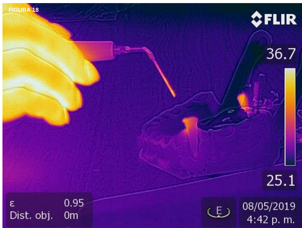
Figura 18. Muestra imagen termográfica donde se realiza protocolo 20 s sin enfriamiento.
