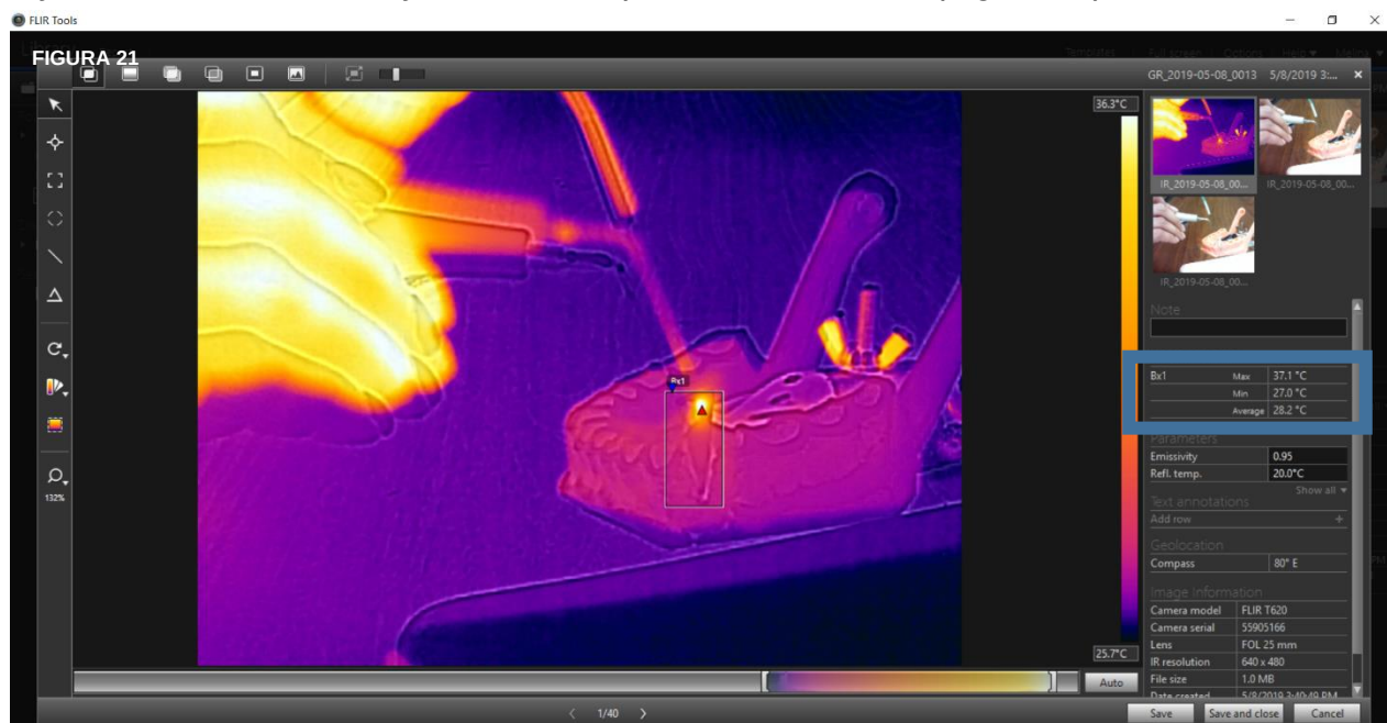
Figura 21. Muestra cómo se obtuvieron las temperaturas máximas alcanzadas con software FLIR Tools.
