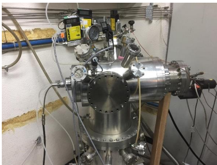
Figura 17. Equipo de erosión iónica utilizado.
