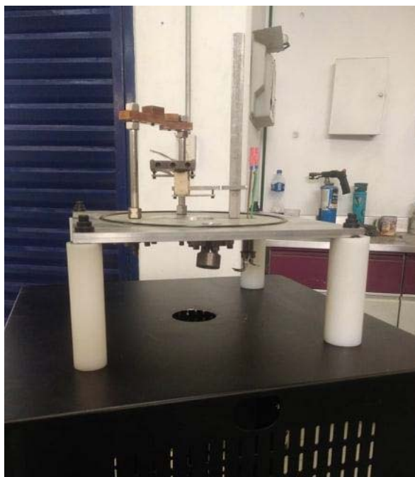
Figura 8.- Placa de aluminio con aditamentos montada en base móvil
