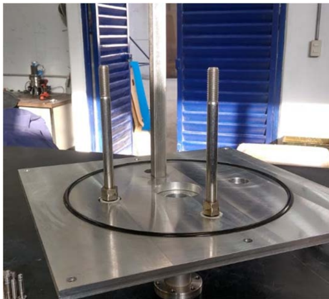
Figura 7.- Tornillos de acero para terminales montados en placa de aluminio.
