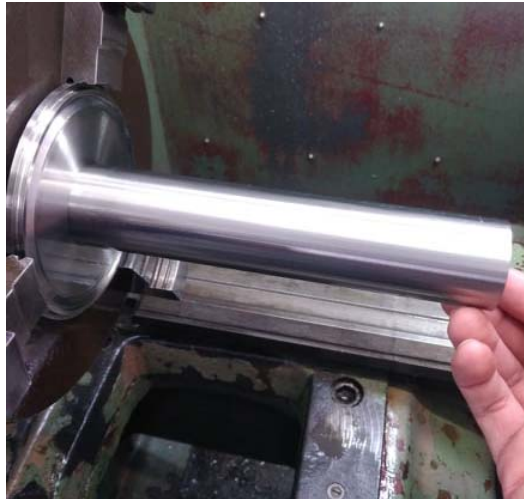
Figura 13.- Extensión de conector realizado para bomba turbomolecular
