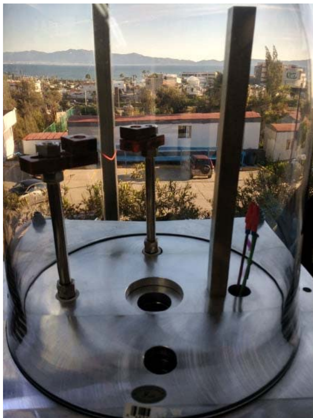
Figura 15.- Prueba de calentamiento de filamento en vacío
