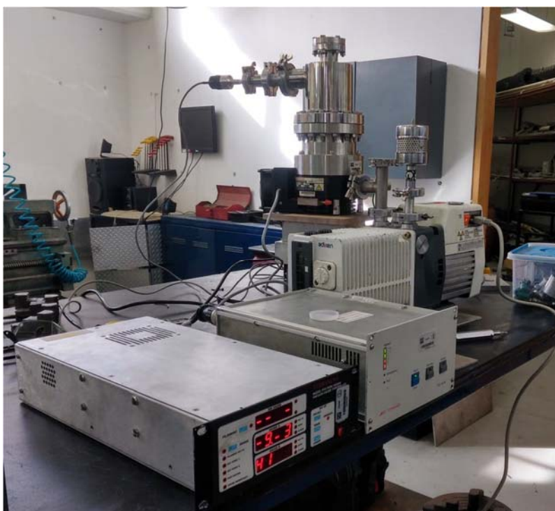
Figura 2.- Prueba 1 del sistema de vacío completo sin montar en la estructura de la cámara.
