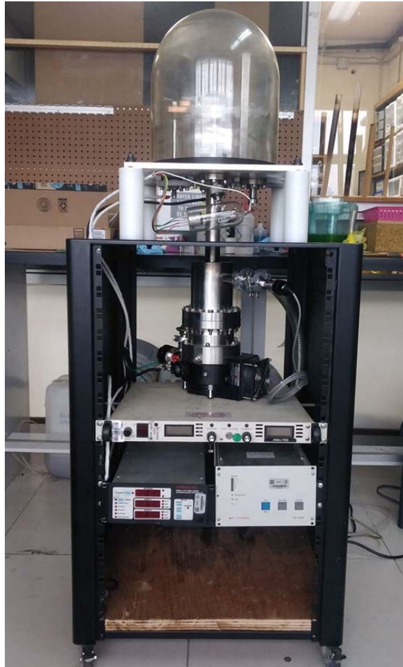
Figura 17.- Sistema para evaporación térmica terminado, el cual es objetivo primordial de este trabajo.
