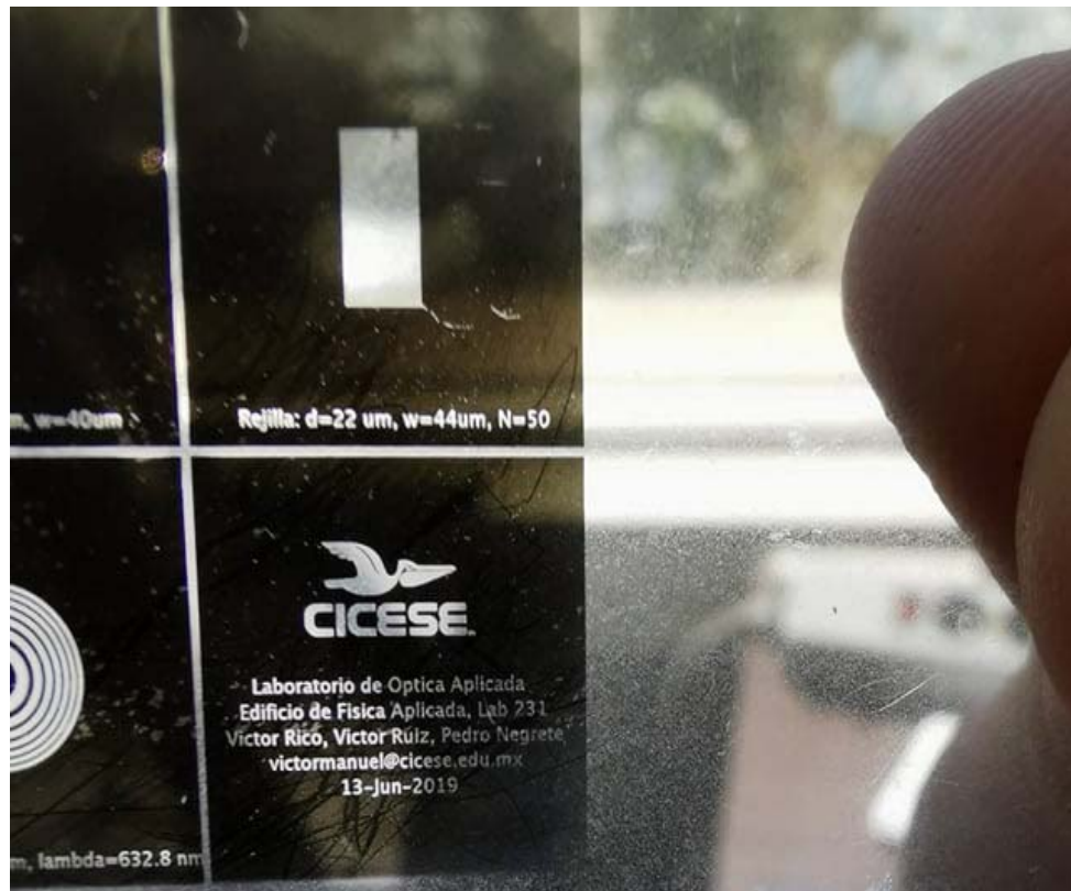
Figura 21.- Plantillas para fotolitografía para depósito de metales
