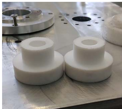
Figura 6.- Imagen de los dos Pasamuros fabricados con teflón para soporte de las terminales
