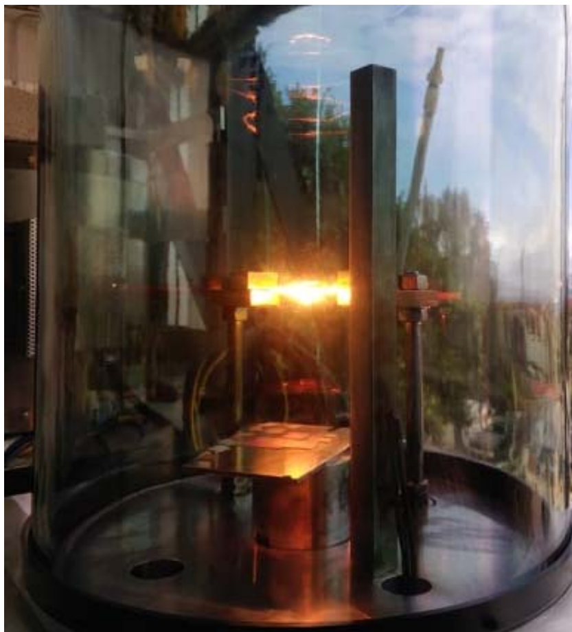
Figura 16.- Fotografía en la que se muestra in situ el depósito de oro sobre un sustrato de silicio
