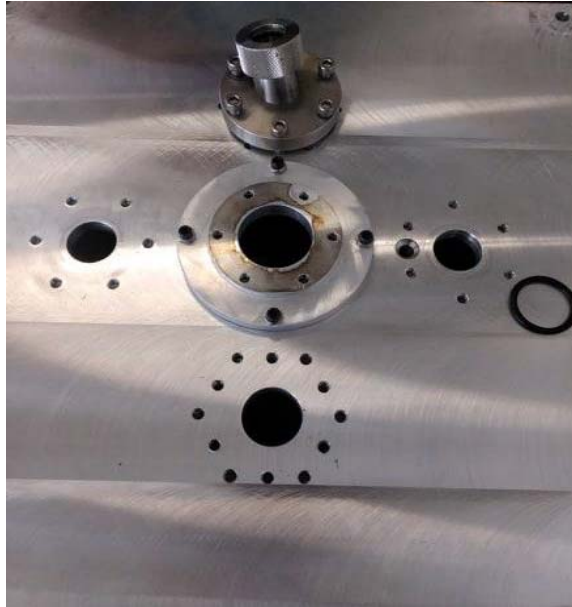
Figura 5.- Orificios en placa de aluminio para la montura de aditamentos
