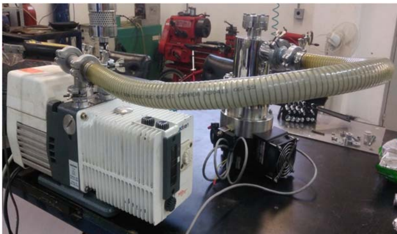
Figura 2.- Prueba 1 del sistema de vacío completo sin montar en la estructura de la cámara.
