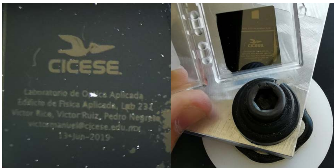
Figura 22.- Depósito de oro con plantilla hecha por fotolitografía
