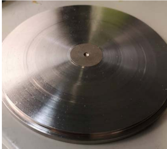
Figura 12.- Tapa superior de conector realizado para bomba turbomolecular
