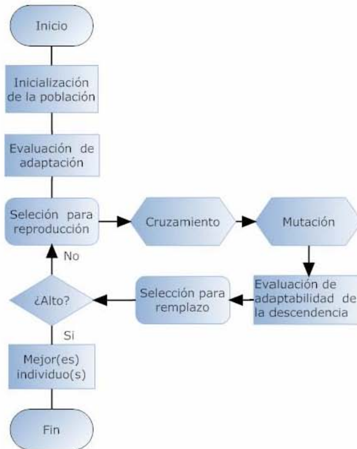
Figura 2.9. Esquema de un algoritmo evolutivo
