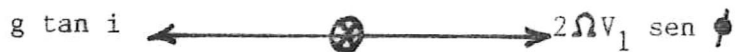
Figura 10. Balance de la resultante horizontal hacia la izquierda g \tan i de la fuerza de presión con la fuerza de Coriolis hacia la derecha, por medio de un flujo hacia dentro del papel (ibid.).
