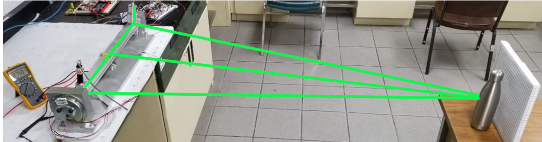
Figura 5.4: Configuración del posicionamiento del sistema y objeto de medición en triangulación estática.
