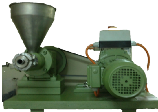
Figura 5. Prensa utilizada para la extracción de aceite de semillas
