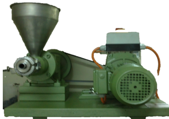
Figura. 5. Prensa utilizada en la extracción de aceite de semilla de algodón [elaboración propia]
