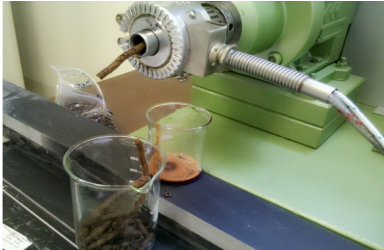
Figura 9. Extracción mecánica de aceite de semilla de algodón
