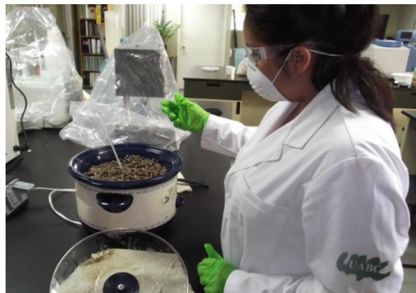
Figura 6. Desborre de semillas de algodón
