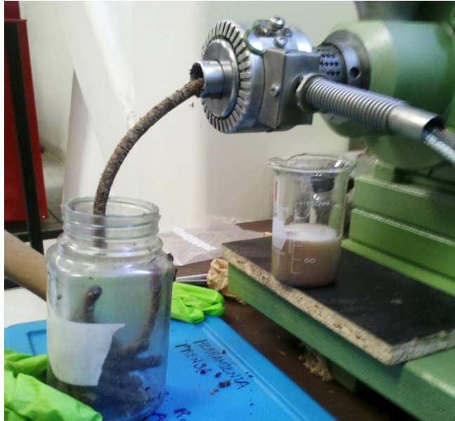
Figura 12. Extracción mecánica de aceite de higuera
