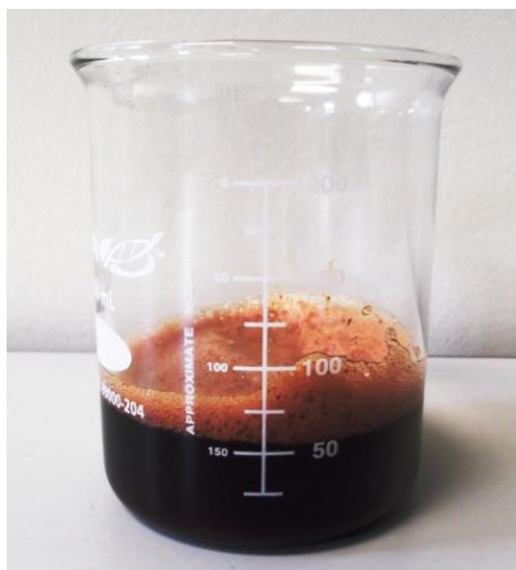
Figura. 6. Aceite crudo extraído por prensado mecánico [elaboración propia]
