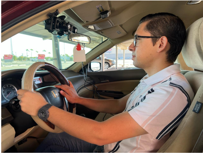
FIGURA 3.15: Vista del sistema de visión estéreo (SVS) y del conductor durante las pruebas del sistema de estimación de pose facial (HPE) para la captura de la base de datos.
