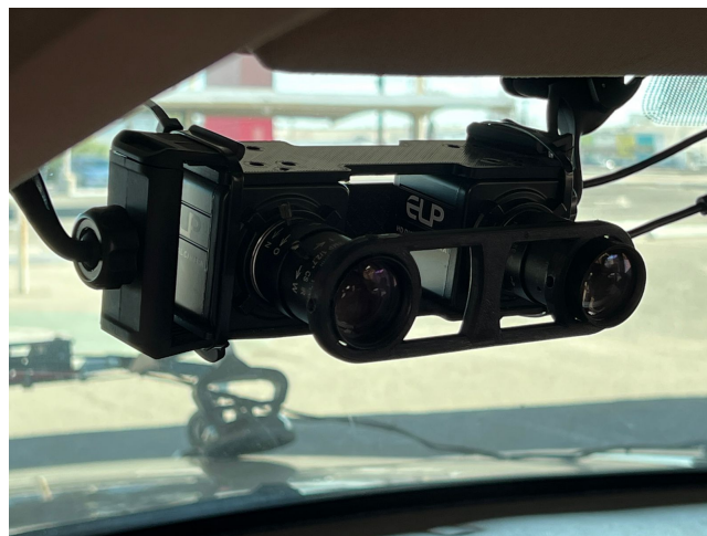
FIGURA 3.1: Sistema de visión estereoscópica (SVS) utilizado para la experimentación dentro de un vehículo.
