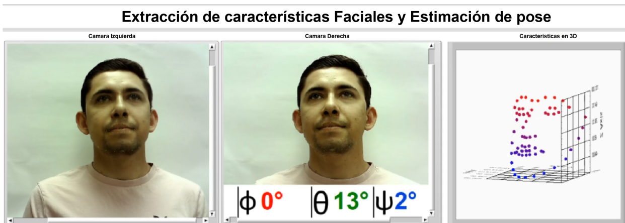
FIGURA 3.14: Ejemplo de resultados de extracción de características faciales y su correspondiente mapa de profundidad, junto con la visualización del ángulo recuperado.
