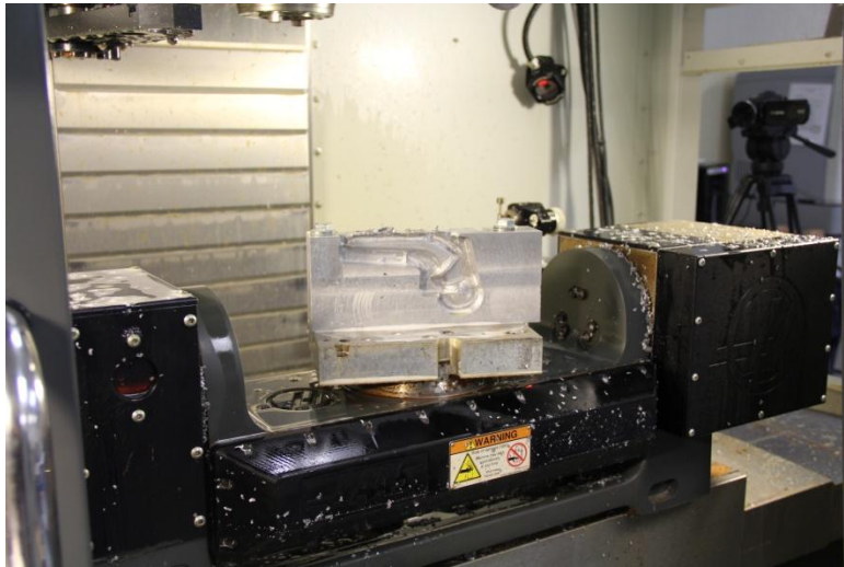
Figura 5.18.- Maquinado parcial de la Prótesis.
