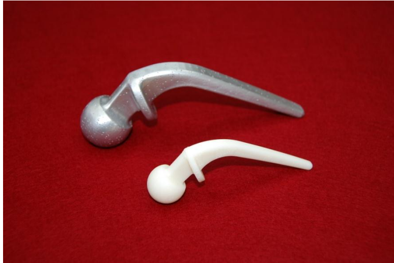
Figura 5.19.- Prototipos de la Prótesis mediante maquinado y prototipado rápido.
