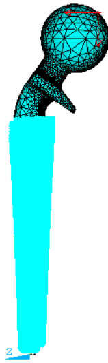
Figura 4.12.- Cargas y condiciones de frontera.
