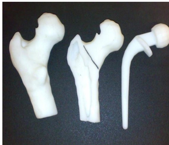
Figura 4.7.- Prototipo del hueso por mediode imágenes TAC o CT.
