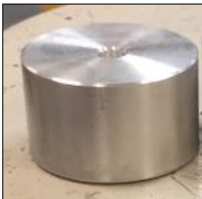
Fig. 3.19 Pieza careada para fabricar preformas [fuente propia]
