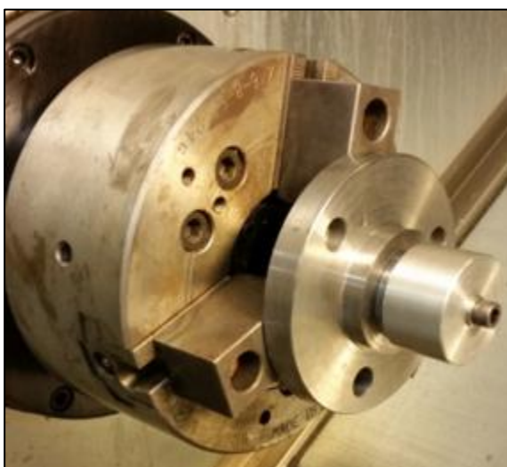
Fig. 3.21 Pieza montada en el aditamento de montaje para fabricación de Preforma [fuente propia]
