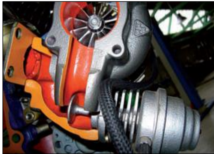
Fig. 1.18 Válvula Wastegate en el turbocompresor [17]
