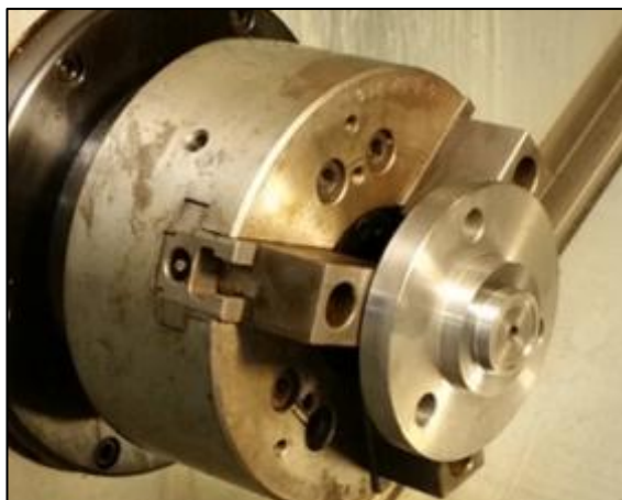
Fig. 3.20 Aditamento de montaje para preparación de preformas para los turbos [fuente propia]
