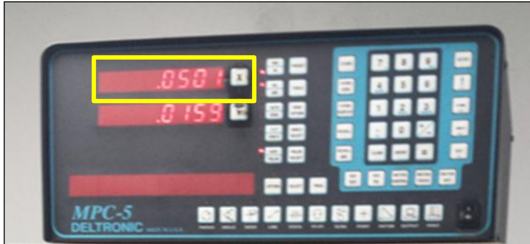
Fig. 4.12 Pantalla del comparador óptico mostrando dimensión del espesor [fuente propia]
