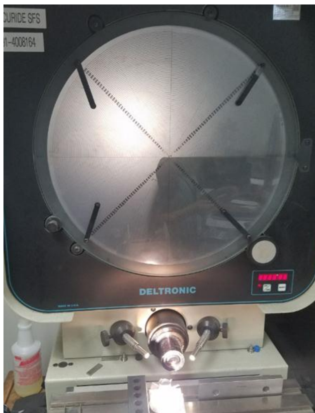
Fig. 4.13 Inspección de alturas de las piezas utilizando comparador óptico [fuente propia]
