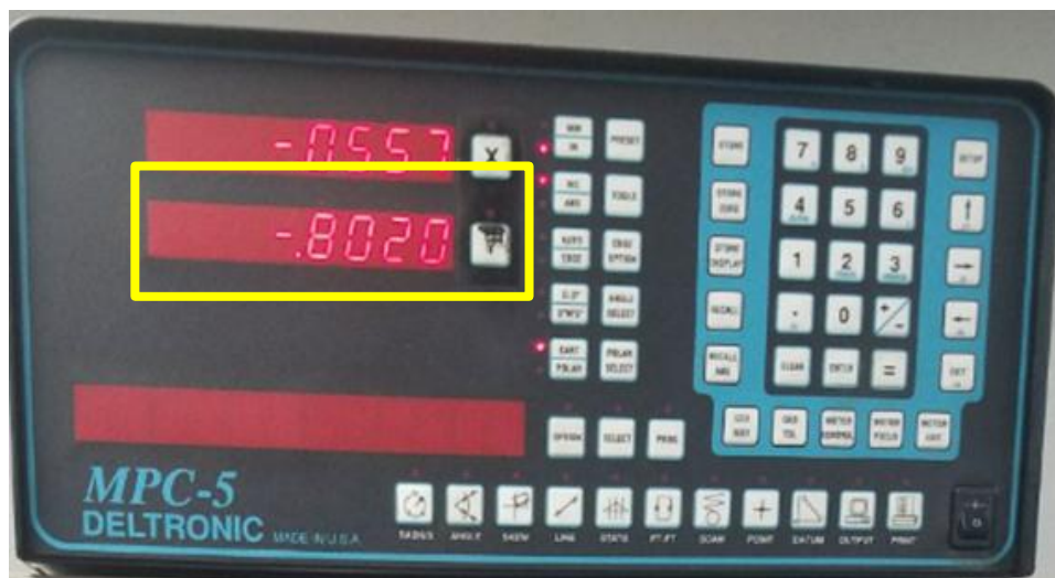
Fig. 4.14 Pantalla del comparador óptico mostrando dimensión de altura [fuente propia]
