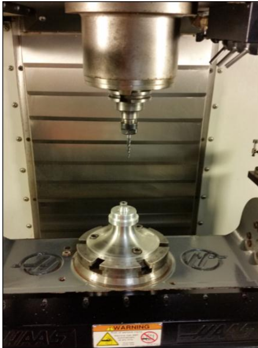
Fig. 3.24 Preforma montada en aditamento para iniciar maquinado de turbo [fuente propia]
