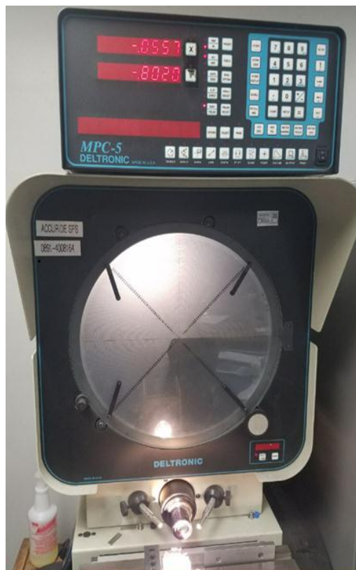
Fig. 4.13 Inspección de alturas de las piezas utilizando comparador óptico [fuente propia]
