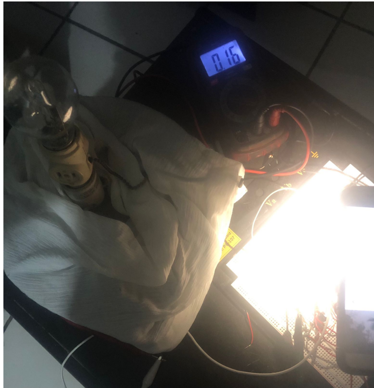
Figura 5.13: Circuito experimental con luz aplicada en las LDR.
