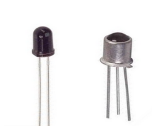
Figura 4.25: Fototransistor de dos y tres terminales.
