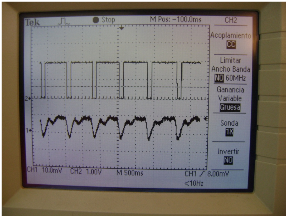
Figura 37. Señal original filtrada y señal cuadrada del comparador de voltaje.
