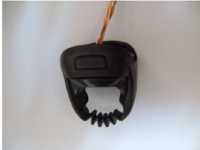
Figura 31. Vista lateral del sensor en estructura de anillo de pulso.
