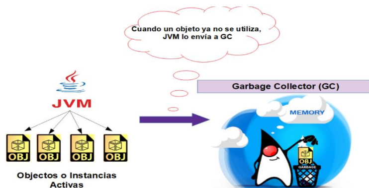
Fig. 50. Esquema de función que desempeña GC cuando un JVM desecha un objeto que no está en uso.
