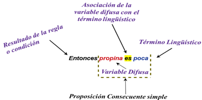
Fig. 25. Ejemplo de la composición de una proposición consecuente simple.
