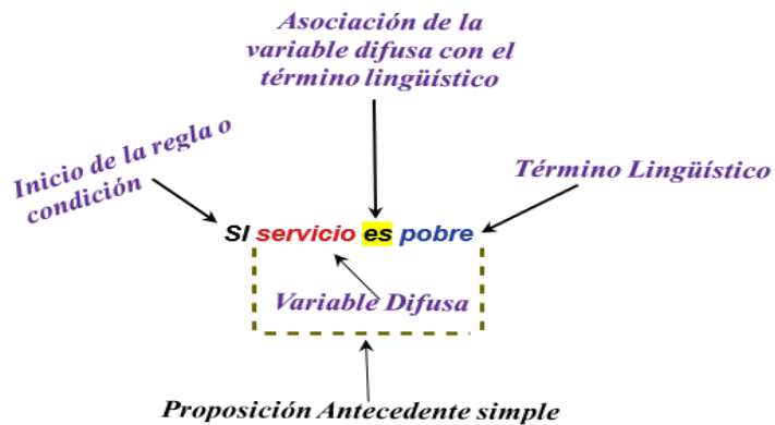
Fig. 16. Ejemplo de la composición de una proposición antecedente simple.
