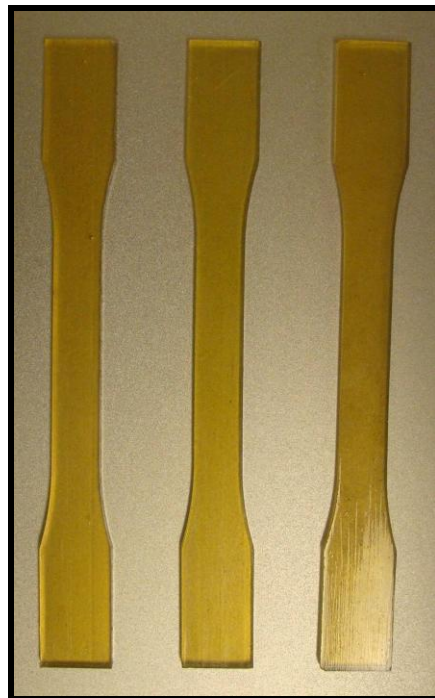
Figura 3. 4 Geometría de las probetas de resina epóxica y poliéster para ensayo de tensión.
