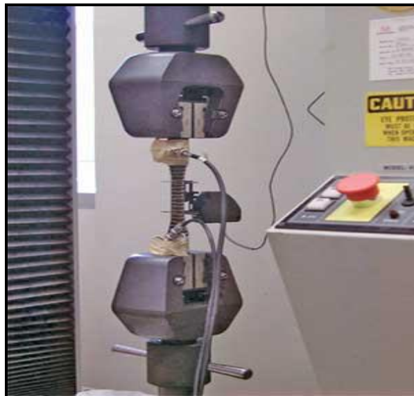
Figura 2. 1.- Material compuesto sujeto a tensión bajo la norma ASTM D3039.
