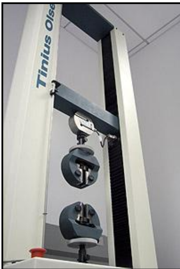
Figura 2. 2.- Equipo empleado para pruebas de tensión y flexión utilizando diversos aditamentos.
