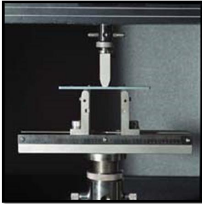
Figura 2. 3.- Equipo empleado en la norma ASTM D790 para flexión en tres puntos.
