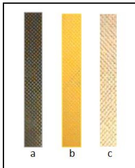
Figura 3. 9 .- Probetas de compuesto laminado para ensayo de tensión,(a) F. carbono, (b) F.aramida, (c) F. vidrio.
