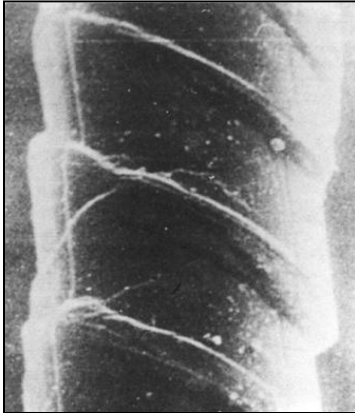
Figura 1. 10.- Deformación de filamento de Aramida sujeto a compresión.
