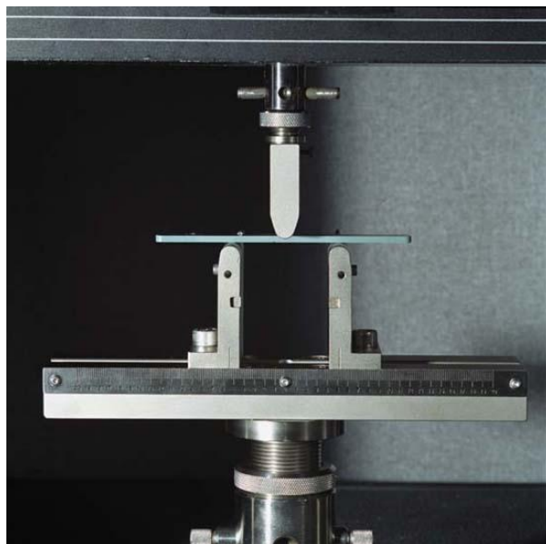
Figura 2. 5.- Probeta de compuesto tipo sándwich sometida a flexión bajo la norma estandarizada (ASTM C-393).
