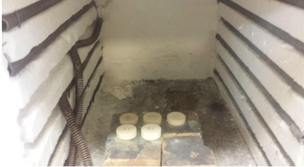
Fig. 2.10 Muestras sinterizadas a 1150 °C, dentro del horno de mufla para laboratorio centro tech ST-1200.
