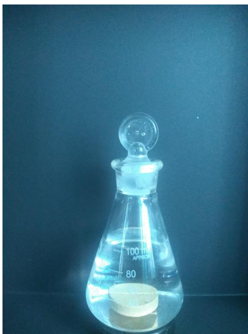
Fig. 2.16 Matraz Erlenmeyer con muestras a ensayar en ácido sulfúrico
