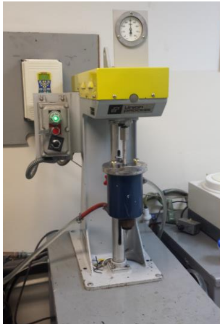
Fig. 2.5 Atritor Union Process, 1/2 hp, 760 cc, control electrónico Baldor.
