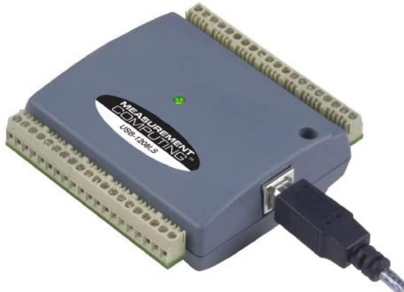
Figura 3.3. DAQ USB-1208LS de Measurement Computing, para adquisición de la señal de opto acoplador.
