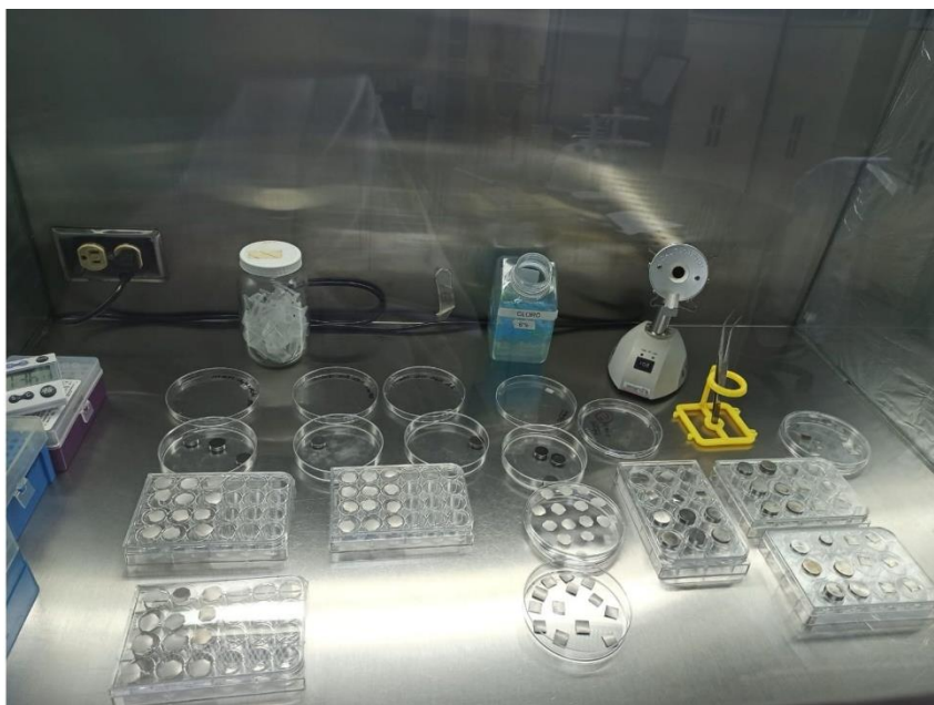
Figura 3.2: En esta imagen se muestran los sustratos dentro de la cabina de bioseguridad para proceder a la esterilización por UV.
