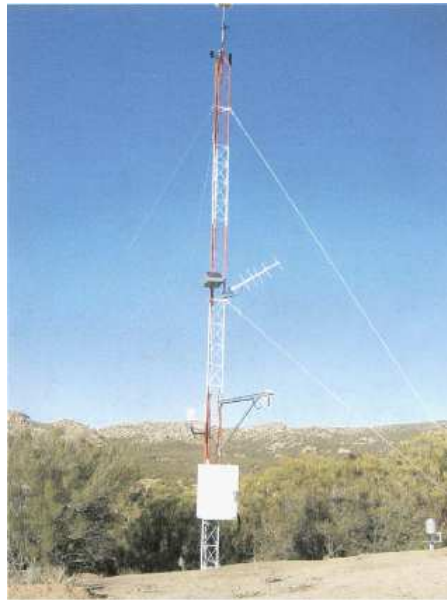
Figura 3.7: Torre anemométrica en Agua Hechicera.
