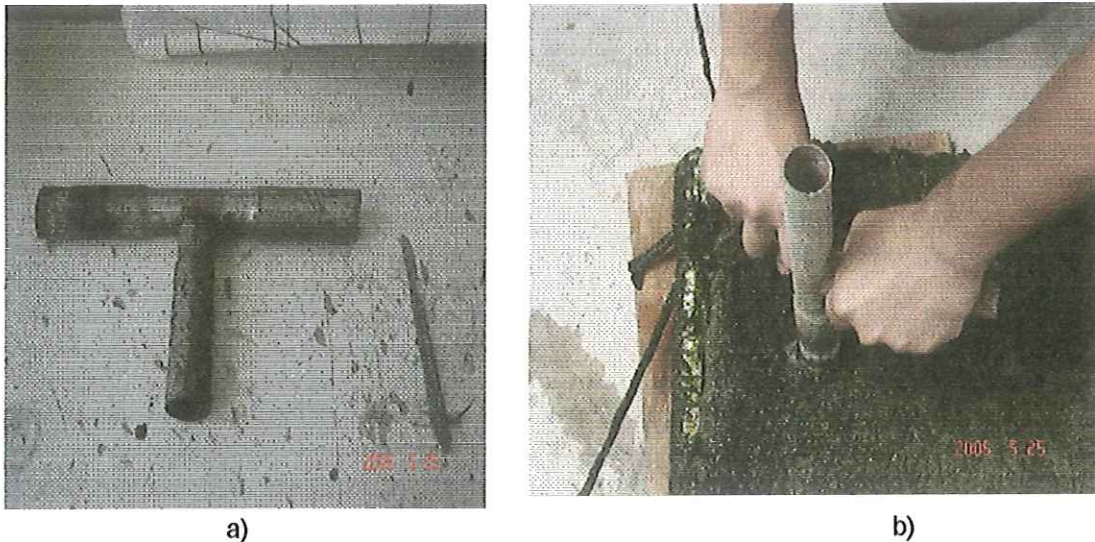
Figura 12.- Imagen del instrumento de muestreo de los tapetes microbianos (a) y ejemplificación de la técnica de corte de los tapetes microbianos (b).
