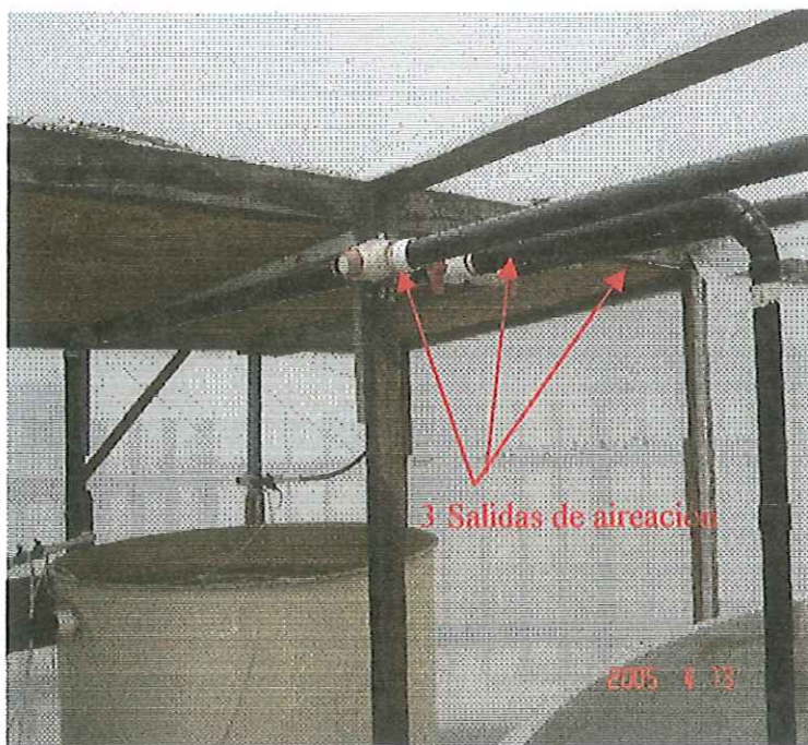
Figura 3. - a) Vista de la estructura de suministro de aire para el tanque (A), realizada con tubería de ABS, b) tres diferentes salidas de aireación dentro del tanque (A).
