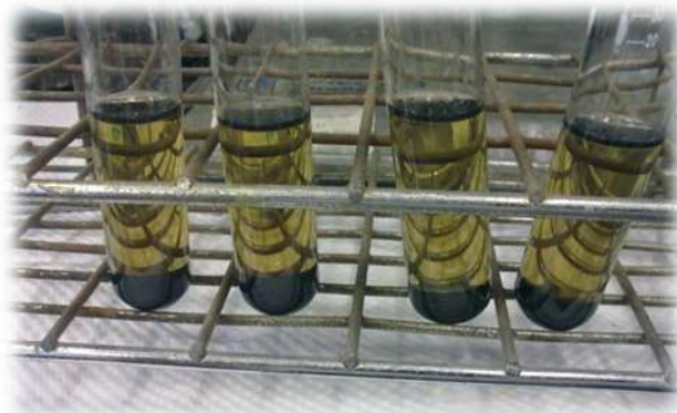
Figura 23. Se aprecia las fases de separación del producto obtenido, después de centrifugar la mezcla resultante del tratamiento de desulfuración con hidrógeno.
