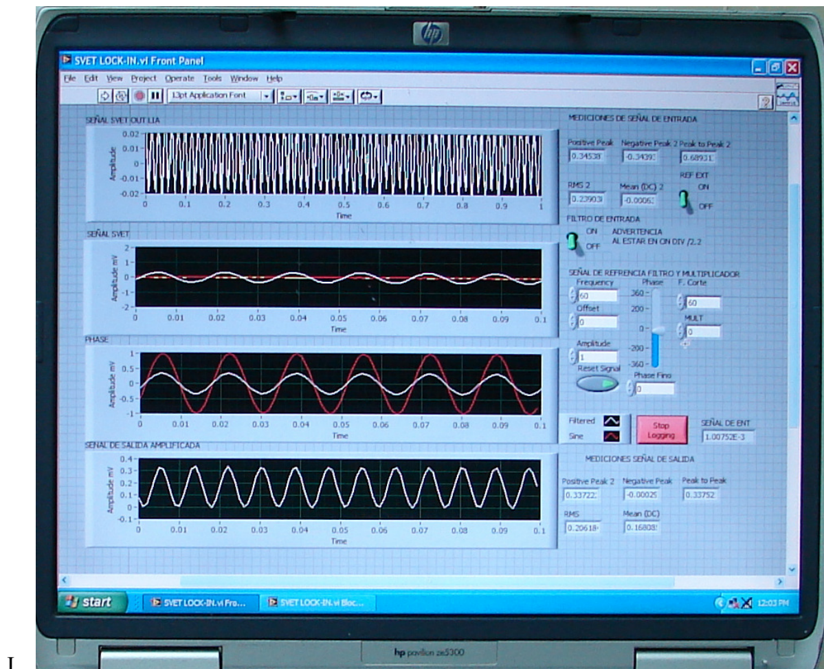
Figura 3-11. Sistema LIA en LabView
