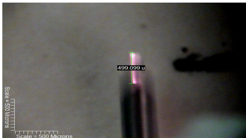
Figura 3-7. Fotografía del electrodo en movimiento con un desplazamiento de 500µm
