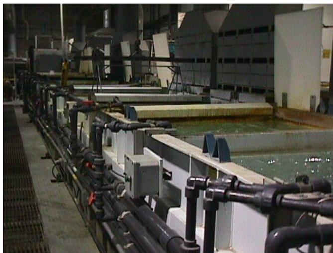
**Figura 14.- Detalle de las instalaciones de una línea de cromatizado donde se pueden apreciar tuberías, baños y sistemas de control y extracción de emisiones.**
