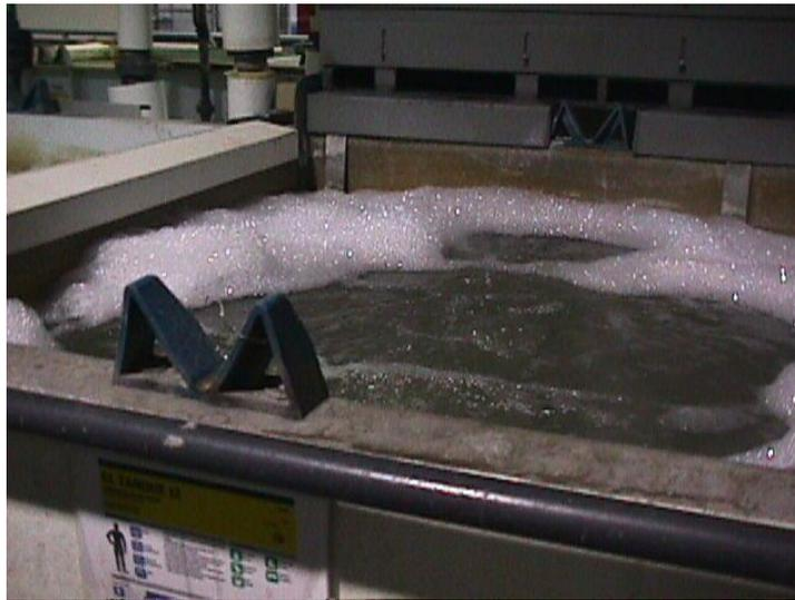
**Figura 13.- Detalle de un baño de limpieza alcalina previo al proceso de cromatizado.**
