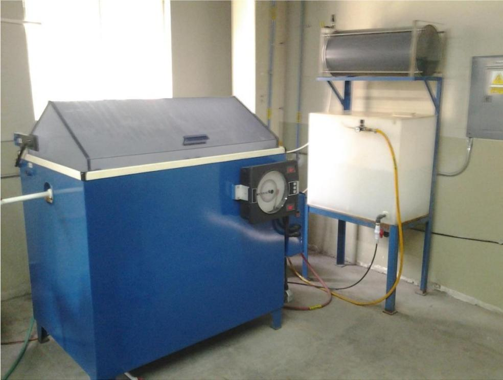
**Figura.- 21 Cámara de niebla salina Auto Technology modelo 22**
