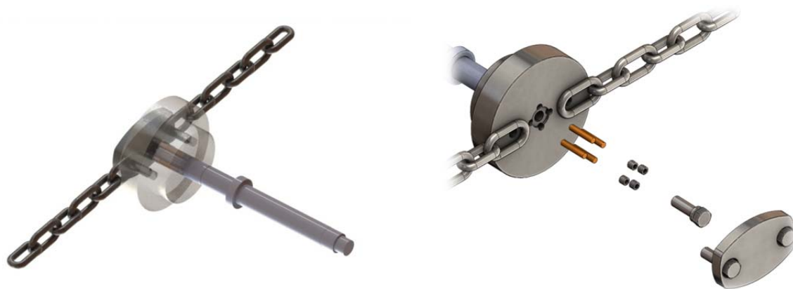
Figura 31 Parte superior del ensamble del cabezal y cadenas
