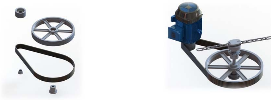
Figura 21 Imágenes del ensamble de las poleas
