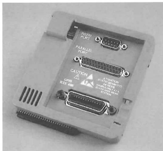
Figura 5) Puertos de interfaz RS-232, Paralelo y GPIB de un osciloscopio comercial.
