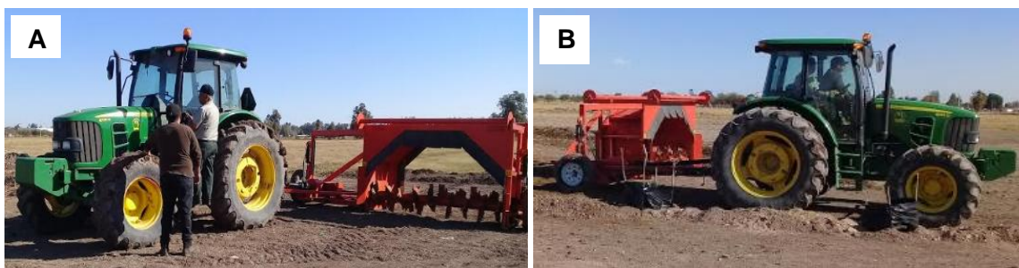
Figura 7.3 Máquina composteadora utilizada en labores de producción. A) Vista anterior de equipo colocado en tractor; B) Vista lateral del implemento.
